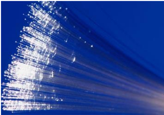
Figura 14 – Fibras ópticas. A luz quando aplicada a uma das extremidades, após percorrer a fibra, sai pela outra extremidade. [29]
