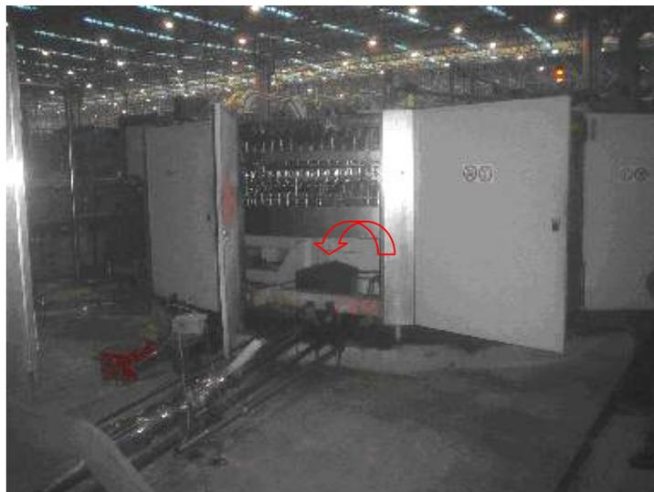
**Figura 7** – Visão interna da cúpula da enchedora onde estão instalados, devidamente lacrados dentro do gabinete de metal (invólucro físico lacrado indicado pela seta vermelha), o medidor de vazão, o condutivímetro e o medidor de temperatura.
