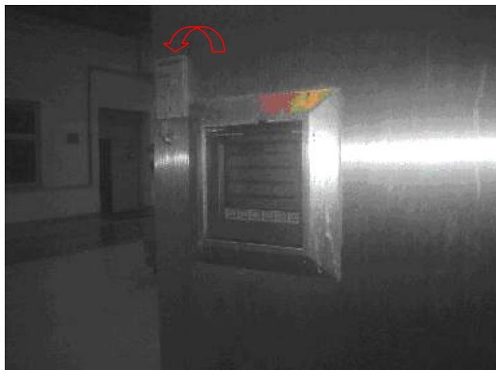
**Figura 8** – Painel de visualização de todos os parâmetros lidos, cujo acesso está devidamente lacrado (lacre acima, à esquerda, indicado pela seta vermelha).
