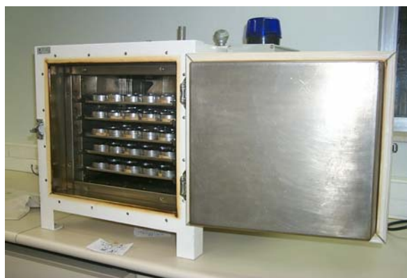
Figura 12 – Forno BAT – Vista Interna
