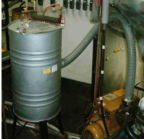
Figura 17 – Sistema GO-POWER M-5000 para medição da vazão de ar no motor
