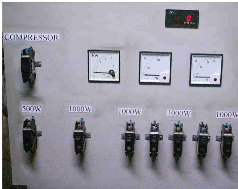
Figura 16 – Painel de controle e simulação de carga elétrica
