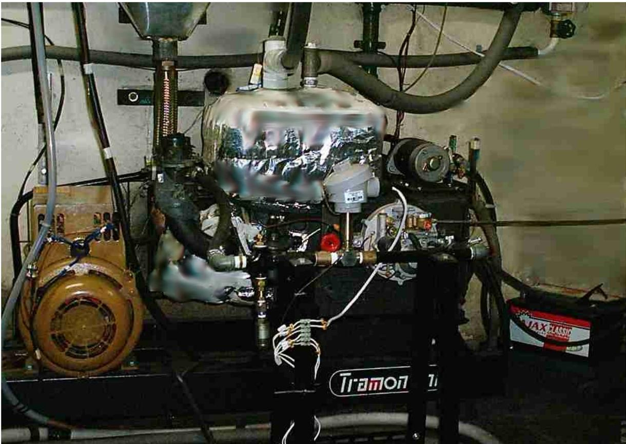
Figura 7 – Conjunto motor–gerador
