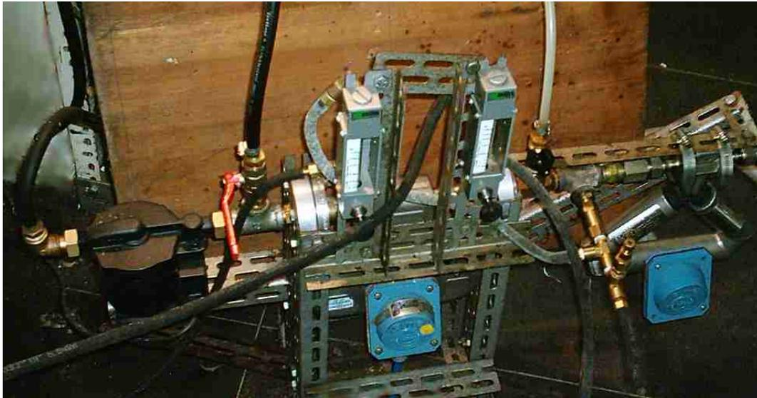
Figura 10 – Sistema de alimentação e medição da vazão do óleo Diesel
