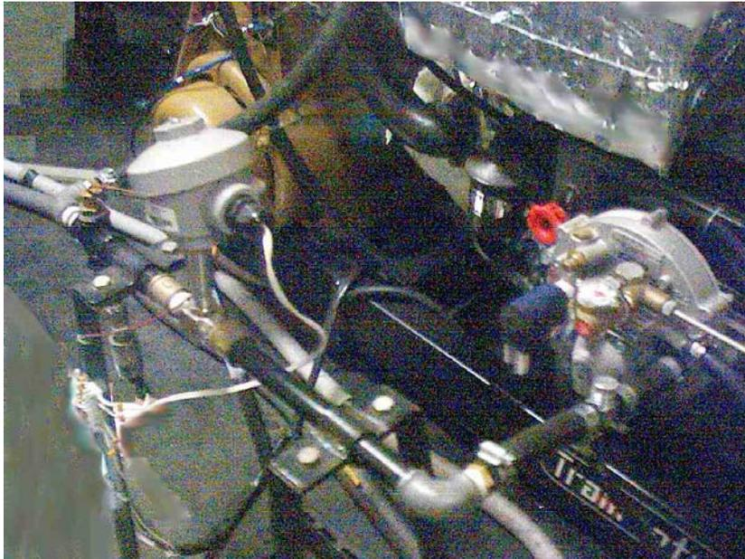
Figura 19 – Medidor de vazão do GNV tipo turbina acoplado ao regulador de pressão do gás
