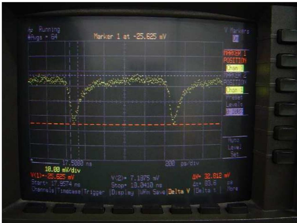
Figura 4.11: Foto de pulsos convertidos, para  $I_{SOA} = 200\text{ mA}$ .  $P_{probe} = 0\text{ dBm}$ ,  $\lambda_{probe} = 1560\text{ nm}$  e  $\lambda_{pump} = 1556\text{ nm}$ . SOA encapsulado,  $V_{bias} = V_{\pi}$ .
