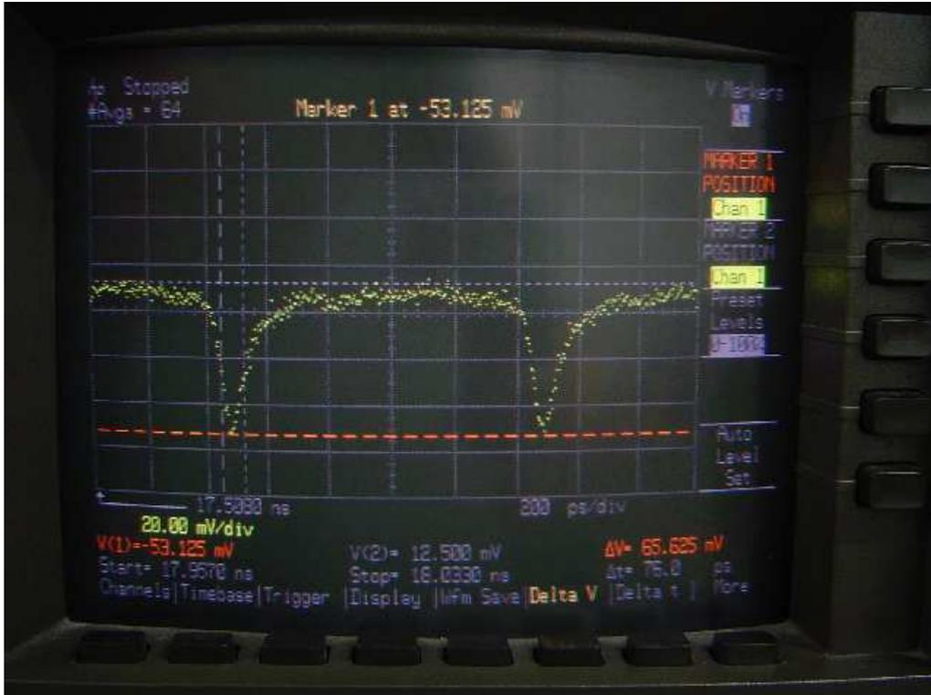
Figura 4.14: Foto de pulsos convertidos, para  $I_{SOA} = 280 \text{ mA}$ .  $P_{probe} = 0 \text{ dBm}$ ,  $\lambda_{probe} = 1564 \text{ nm}$  e  $\lambda_{pump} = 1556 \text{ nm}$ . SOA encapsulado,  $V_{bias} = V_{\pi}$ .
