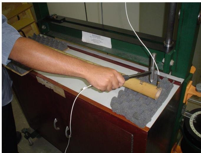
Figura 3.12 – Obtenção da FRF Pontual.
