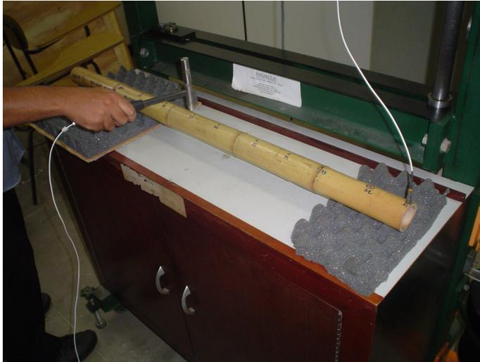
Figura 3.13 – Obtenção de uma FRF de Transferência.
