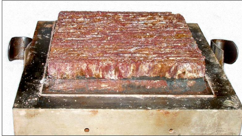
Figura 12 - Corpo-de-prova de interface solo/nata de cimento após o ensaio.
