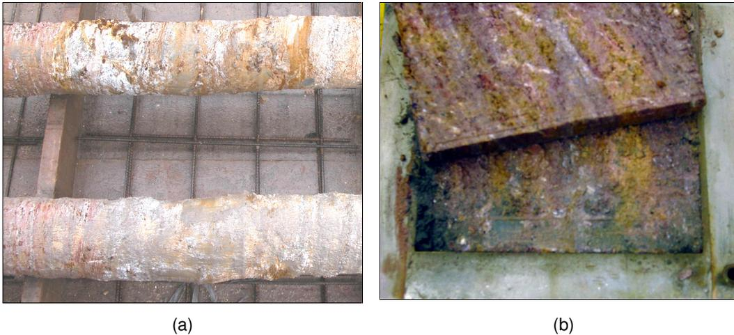
Figura 11 Comparação das rugosidades: (a) grampos exumados em campo; (b) interface solo/nata de cimento no laboratório.
