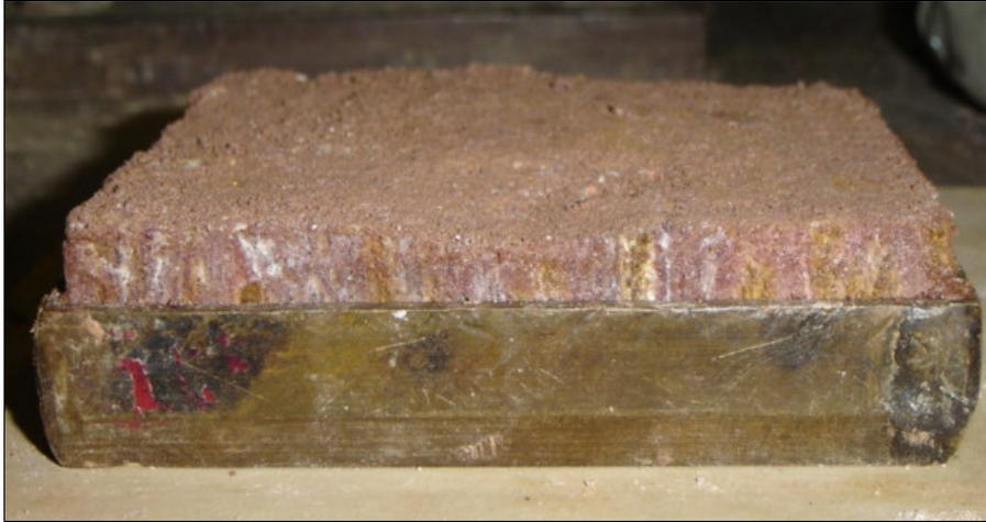
Figura 7 – Corpo-de-prova no molde para o faceamento da metade superior.
