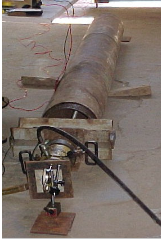
Figura 6 - Sistema dos ensaios de calibração das barras.
