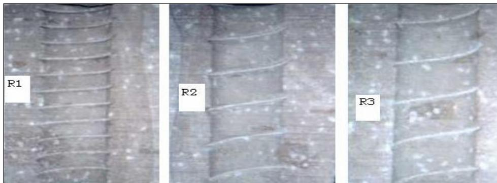
Figura 14 - Perfis dos padrões de rugosidade R1, R2 e R3 dos modelos reduzidos estaca-rocha (Nunes e Castilhos, 2002).
