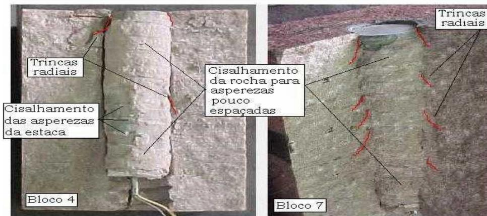
Figura 15 – Modo de ruptura dos modelos reduzidos estaca-rocha de fuste muito rugoso tipo (Nunes e Castilhos, 2002).
