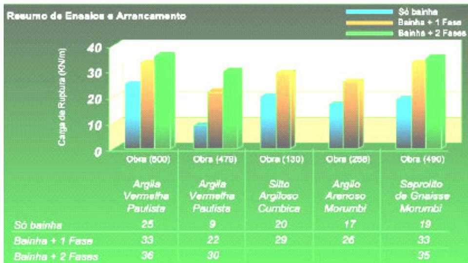
Figura 28 - Resumo comparativo da resistência ao arrancamento de grampos em função da reinjeção (Pitta et al., 2003).
