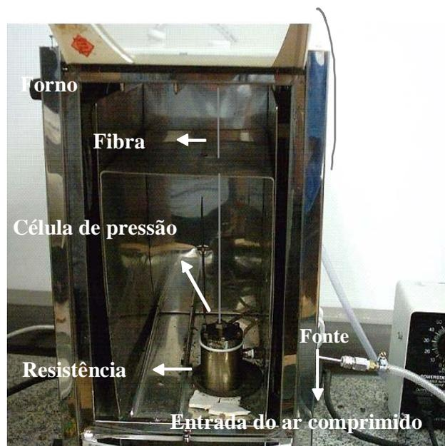
Figura 83 - Forno com a célula de pressão e a fibra em seu interior. Na direita a fonte conectada à resistência para aquecer a liga.
