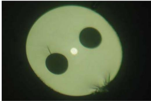
Figura 77 - Fibra F020523-8. Casca de sílica fundida. Distância núcleo-buraco  $18 \mu\text{m}$ . Diâmetro do buraco  $30 \mu\text{m}$ . Diâmetro do núcleo  $10 \mu\text{m}$ .
