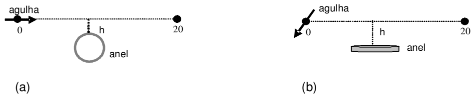
Figura 5.2 – Diagrama do experimento em uma dimensão, (a) anel sensor na configuração vertical, (b) anel sensor na configuração horizontal.
