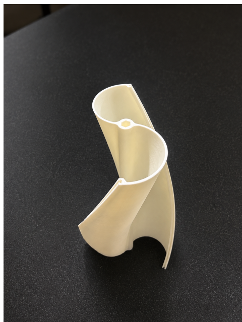
(a) Turbina Suporte impressa
