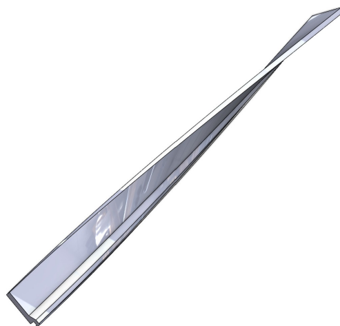
Figura 3-6: Bordo de Fuga Retangular modelado no Solid Works
