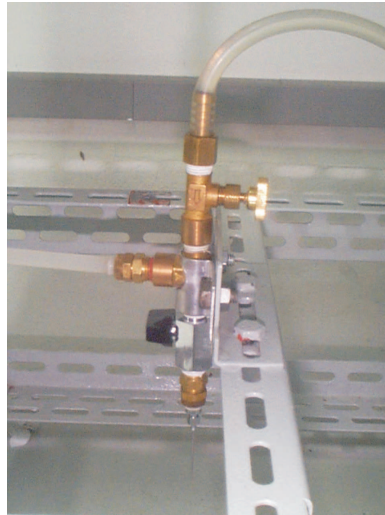
Figura 4.10: Conjunto de válvulas e agulha de controle.
