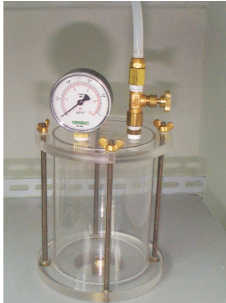
Figura 4.7: Reservatório de fluidos.
