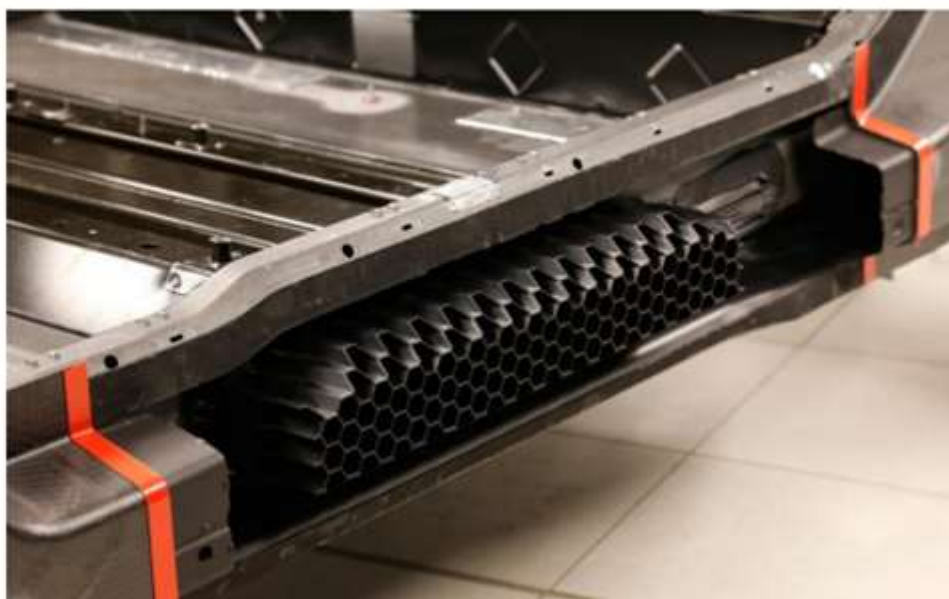
Figura 4.7: Elongarina do BMW i3 Reforçada com Núcleo Honeycomb
