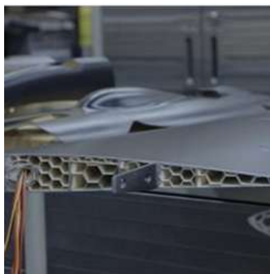
Figura 5.4: Corte transversal da asa mostrando a aplicação da estrutura honeycomb no design de drone impresso em 3D
