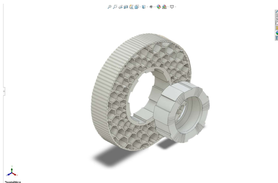
Figura 5.8: Anel de Tensionamento e Núcleo Honeycomb da Roda Morphing
