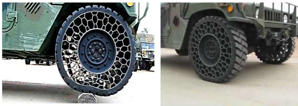
Figura 5.5: Pneu automotivo com estrutura celular.
