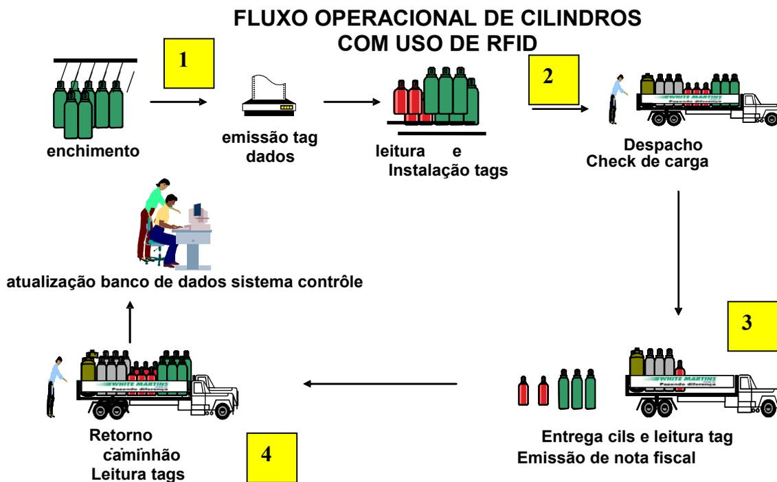
Figura 14: Fluxo das operações de produção e distribuição com uso de *RFID*
