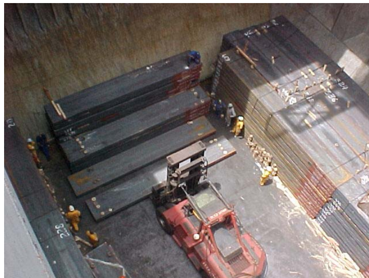
Figura 07 - Estivagem das placas pelo método vertical Fonte: CST
