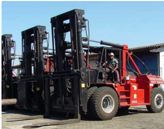
Figura 04 – Empilhadeiras utilizadas no carregamento das placas de aço nos navios Fonte: CST
