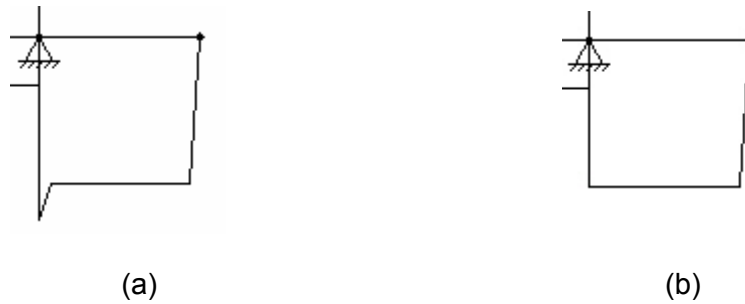
Figura 6.23– Envoltória de esforço cortante no balanço da estrutura do Exemplo 4 utilizando o trem-tipo do Caso 1 .
