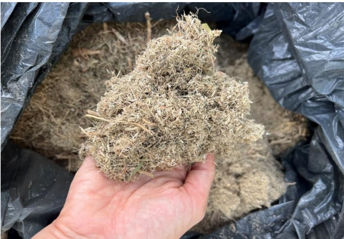
Figura 10- Substrato de Eichhornia crassipes após secagem em temperatura ambiente e trituração em máquina forrageira. Fonte: acervo pessoal, 2024.
