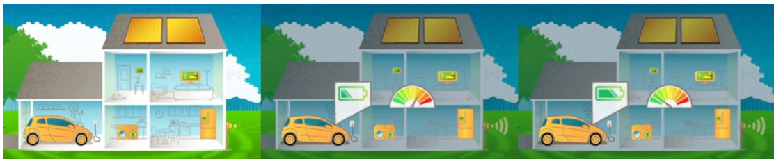
Figura 6.25: Veículo elétrico ligado à smart home (esquerda), serve de bateria durante consumo elevado (centro) e recarrega durante consumo baixo (direita).
