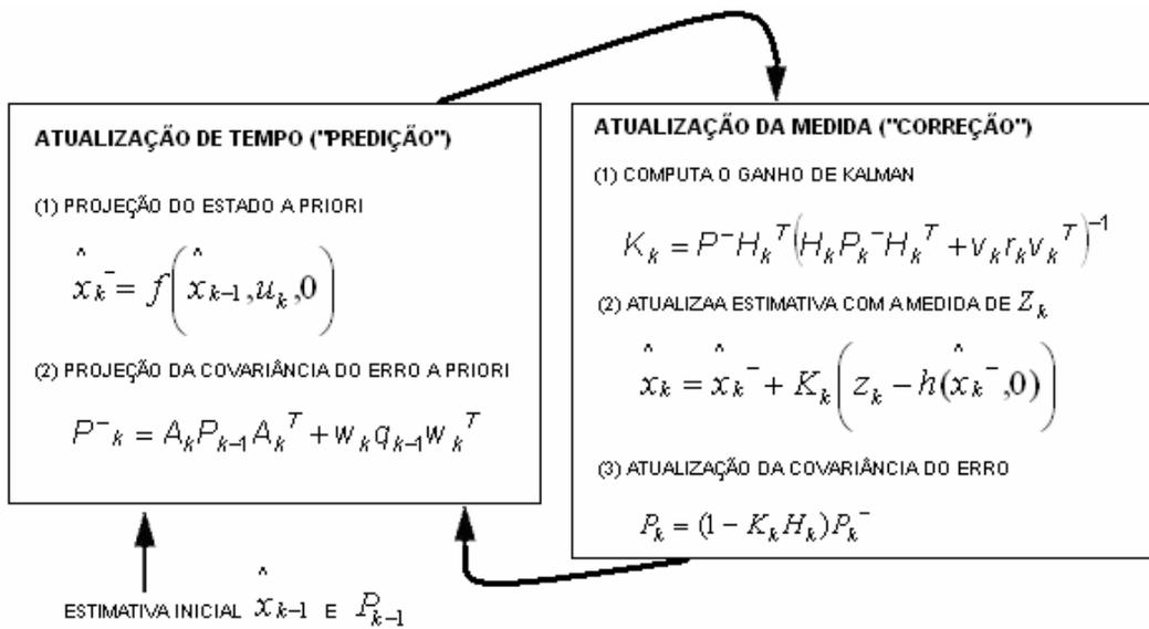
Figura 2: Algoritmo do filtro de Kalman estendido.
