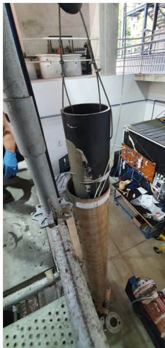
Figura 57: Casing 9 5/8" cimentado na vertical.
