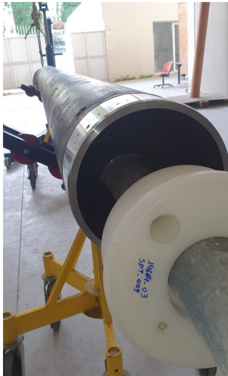
Figura 36: Centralização do tubing e inserção do plug superior intermediário.
