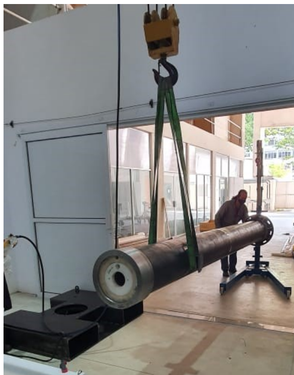
Figura 37: Içamento da bancada de teste.
