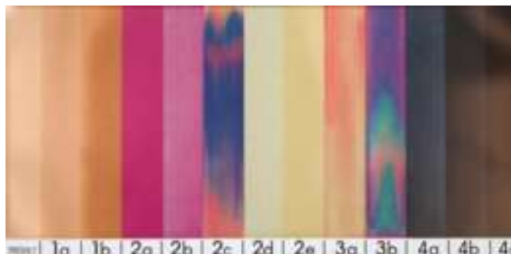
Figura 8: Padrões de classificação do ensaio de corrosão ao cobre segundo a norma ASTM D130 (1a a 4c). Fonte: Adaptado de ITOIL (2025). Disponível em: https://itoil.com.br/analises-especiais/ .
