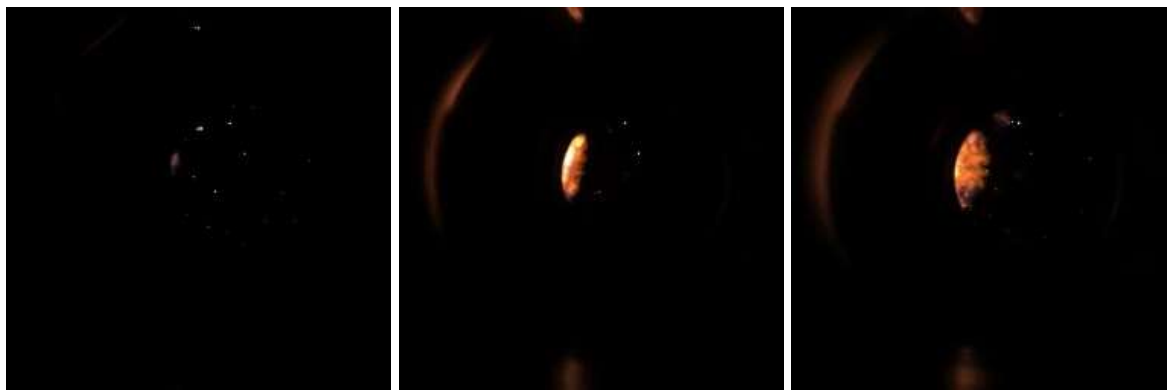
Figura 16: Imagens do processo de combustão para a mistura E100 (1), ensaiada em RC = 25,02 e avanço de 3 mm antes do PMS.
