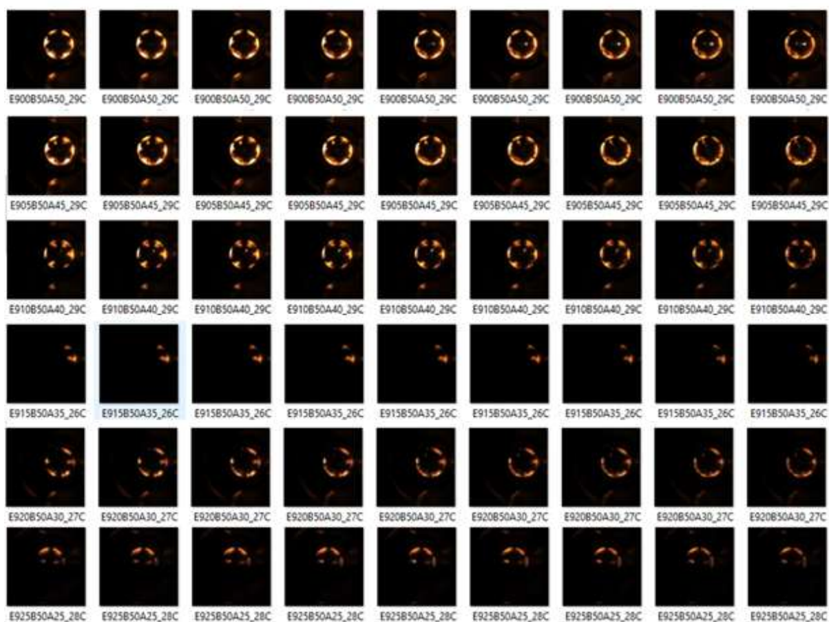
Figura 25: Efeito da composição da mistura de combustível na formação da frente de chama em condições de partida a frio.
