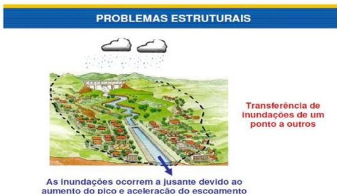
Figura 10-Problemas estruturais – transferência de pontos de inundação
