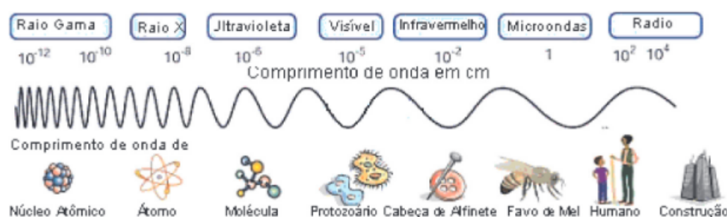
Figura 2.7: O espectro eletromagnético. Fonte: http://imagers.gsfc.nasa.gov/ems/waves3.html .
