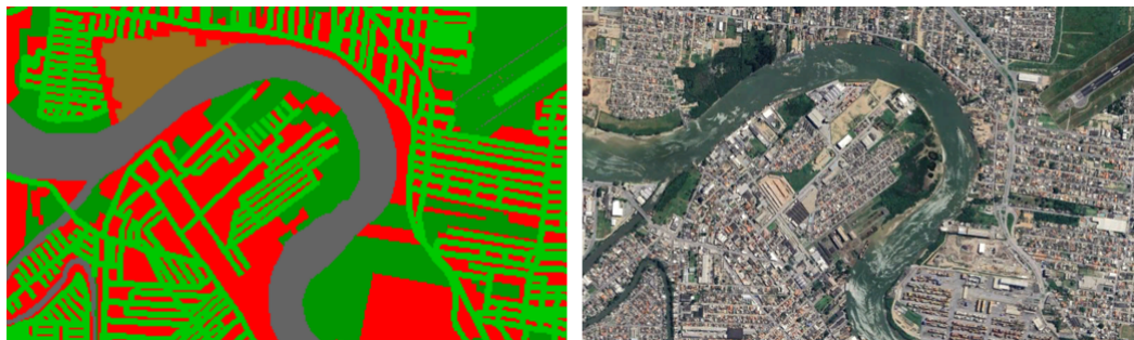
Figura 2.13: Comparação entre parte de uma carta de trafegabilidade e uma imagem satélite. As áreas urbanas, estradas e rios correspondem à trafegabilidades específicas segundo as cores estabelecidas.
