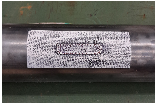
Figura 3.2: Speckle pattern criado na área de interesse do vaso de pressão para análise DIC.
