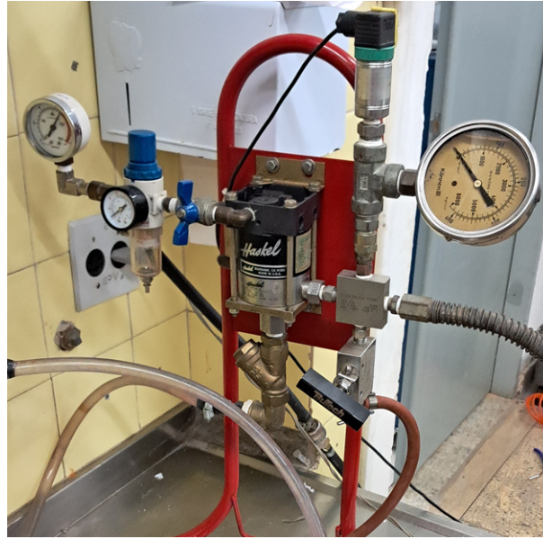
Figura 3.7: Bomba hidropneumática usada para aplicação de pressão interna.
