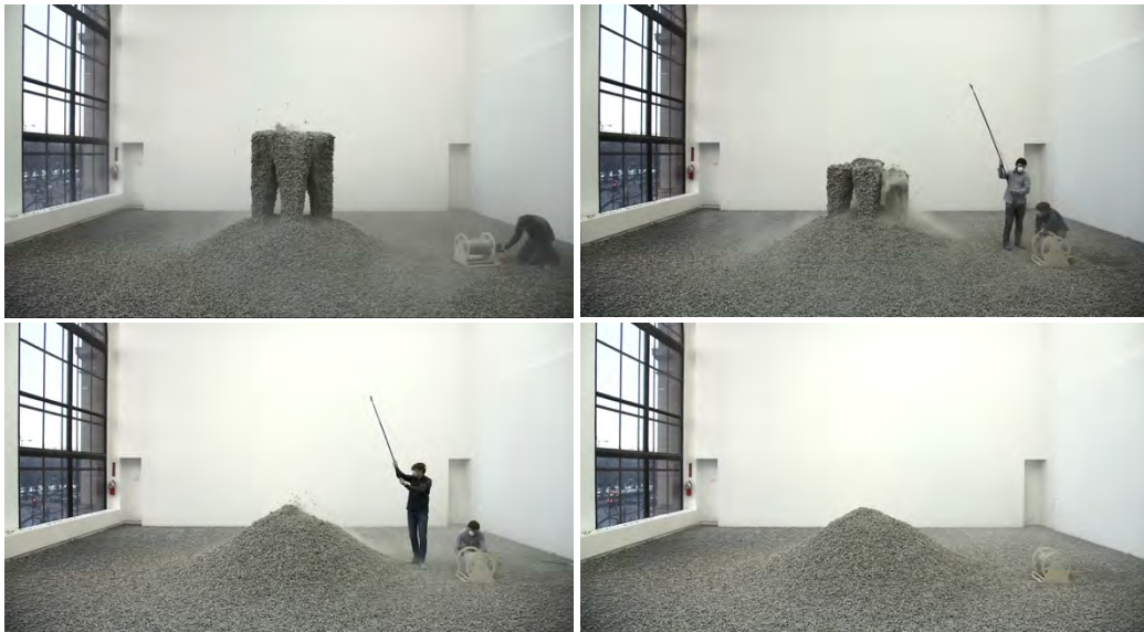
Figura 36 - Processo de desmontagem, através do recolhimento do rolo de barbante Fonte: Gramazio Kohler Research
