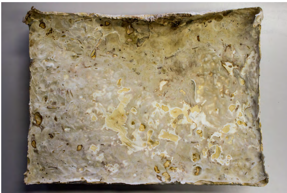
Figura 50 - Pannel de micélio do fungo Reishi Fonte: Antoni Gaudí / Mediamatic
