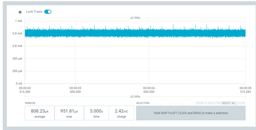
Figura 5.4: System poweroff : consumo médio de 808 \mu\text{A} .
