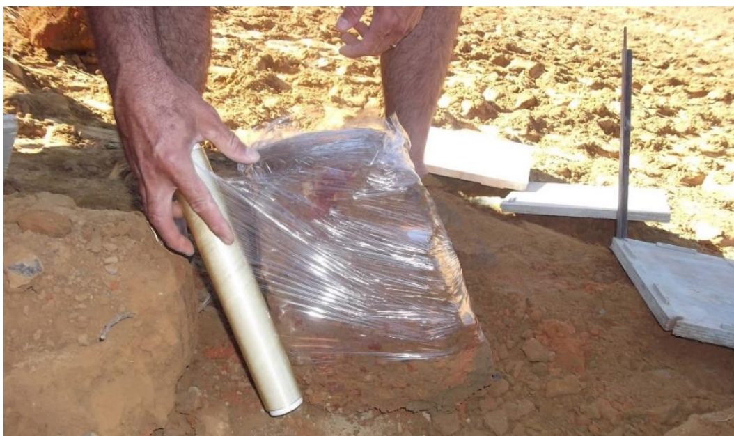
Figura 64 – Bloco da amostra indeformada da barreira mineral de fundo da célula de disposição final do aterro industrial de rejeitos de rochas ornamentais sendo coletado.
