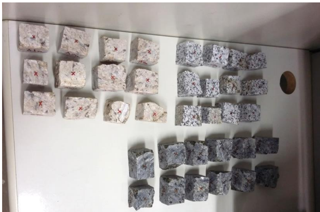
Figura 55 – Detalhe dos 36 corpos de prova de formato irregular e cúbico para os ensaios de resistência puntiforme.
