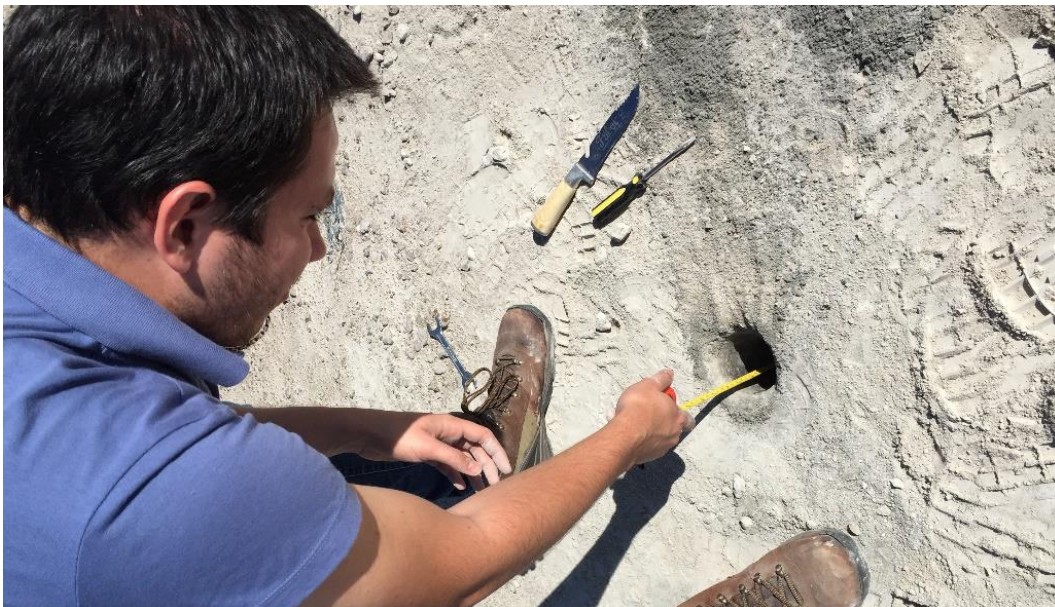
Figura 78 – Verificação das dimensões do poço de sondagem escavado na camada superficial de rejeitos (lama do beneficiamento), para a realização do ensaio com o Permeômetro Guelph.
