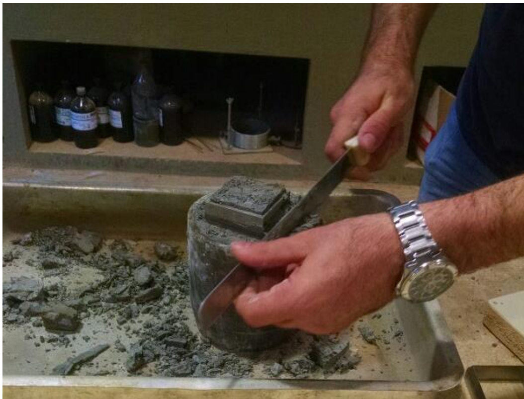
Figura 71 – Retirada dos corpos de prova do tubo Shelby, para os ensaios de cisalhamento direto.
