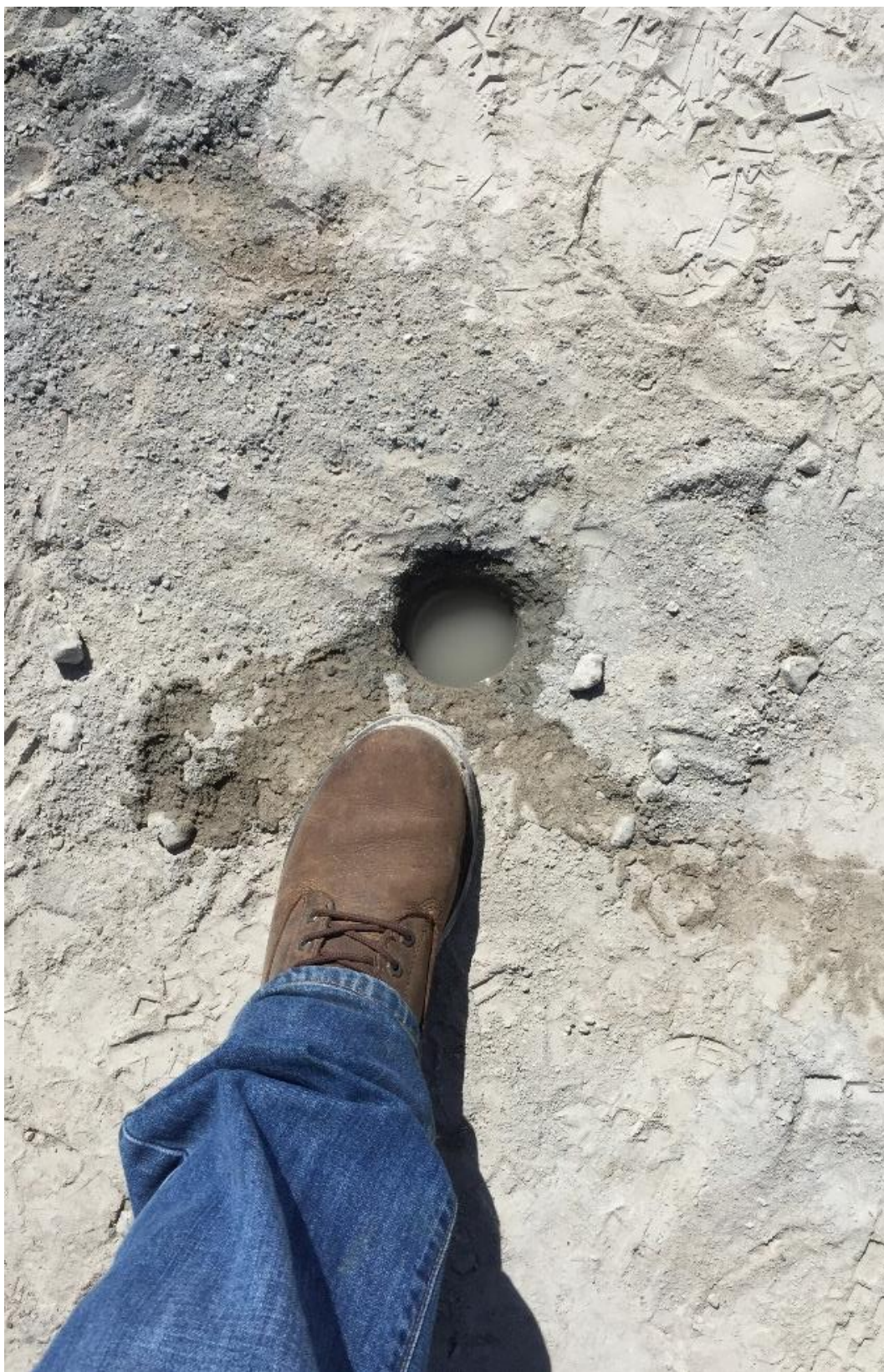
Figura 79 – Poço de sondagem escavado na camada superficial de rejeitos (lama do beneficiamento), preenchido com água durante a realização do ensaio com o Permeâmetro Guelph.
