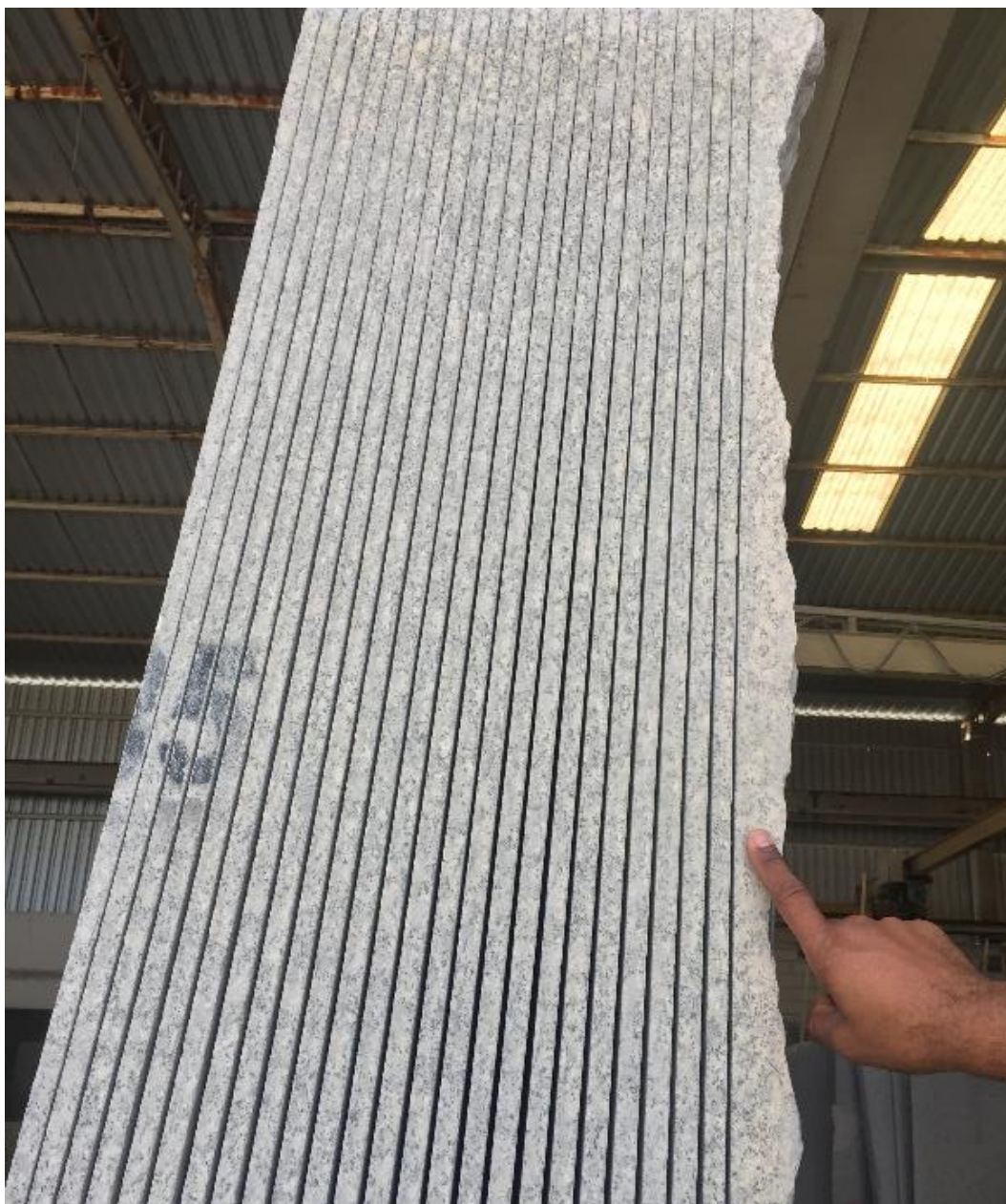
Figura 46 – Detalhe, à direita na foto, do casqueiro com dimensões irregulares a ser descartado, gerado no corte lateral do bloco de granito.
