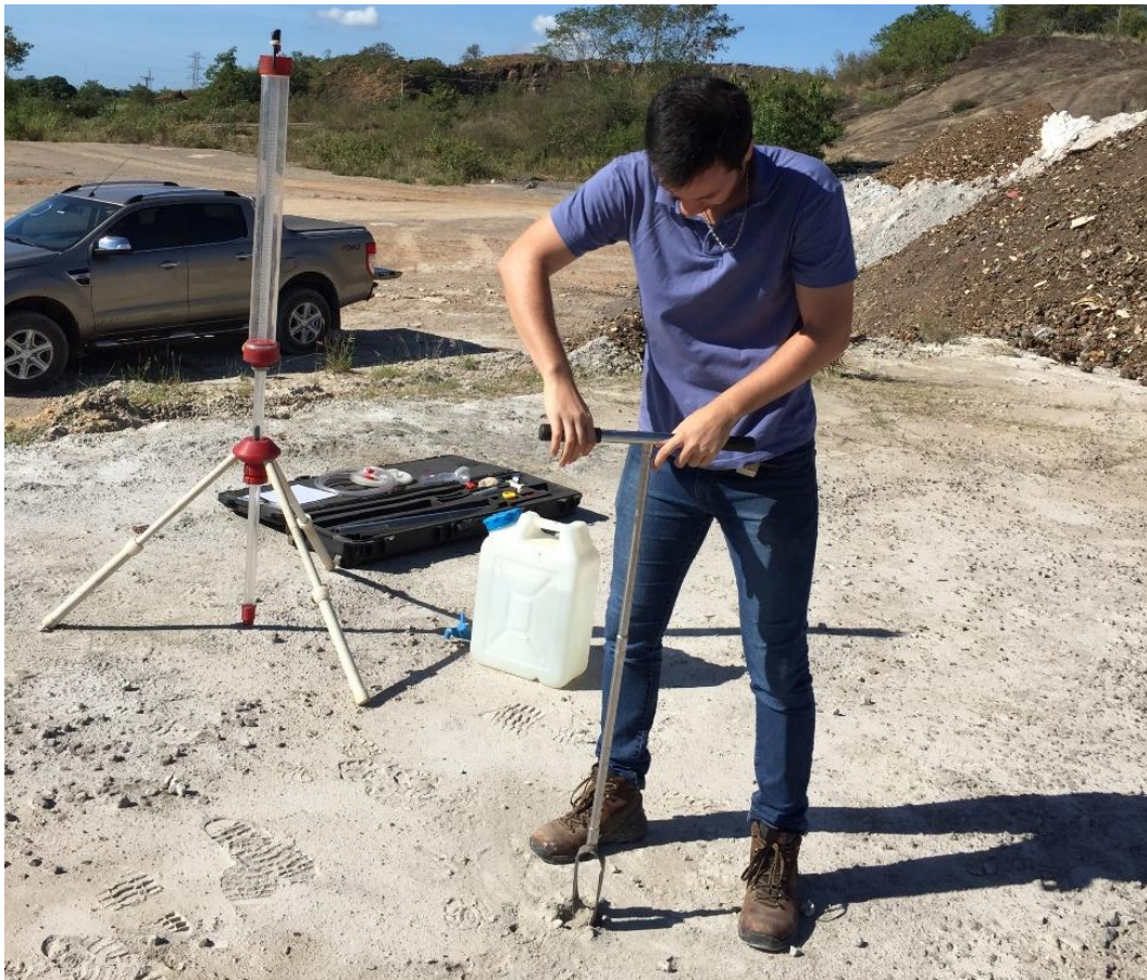
Figura 77 – Montagem do Permeômetro Guelph em uma das camadas superficiais de rejeitos (lama do beneficiamento) no aterro monitorado.
