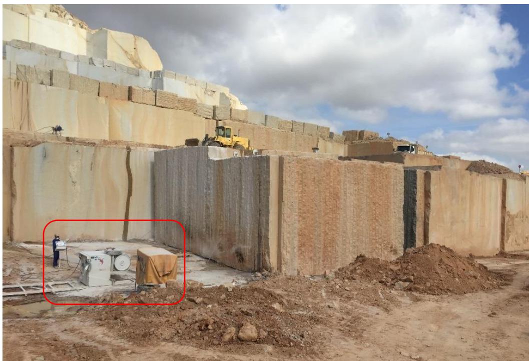
Figura 81 – Corte de bancada com altura múltipla e detalhe do equipamento com fio diamantado, em pedreira de granito amarelo situada no norte do ES.
