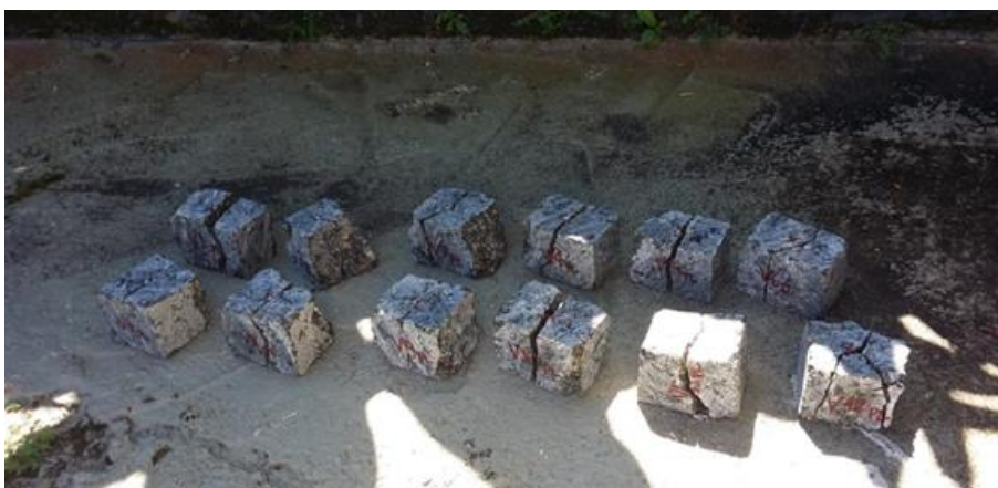
Figura 98 – Corpos de provas do granito verde pavão após a ruptura no ensaio de resistência à compressão à carga puntiforme.
