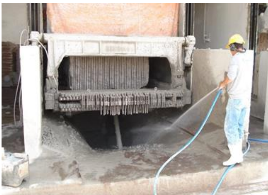
Figura 6 – Bloco de granito sendo desdobrado em tear convencional multilâminas.
