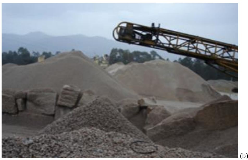
Figura 17 – (a) Vista da jazida de exploração do granito rosso porriño e (b) de britador móvel utilizado na área da exploração, para a produção de areias e britas.
