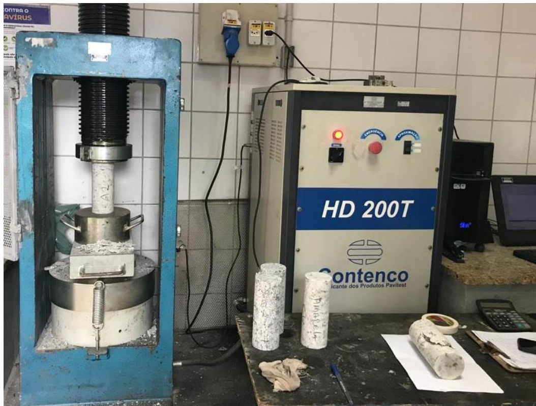
Figura 53 – Prensa hidráulica utilizada para os ensaios de resistência à compressão simples (Laboratório BRASCONTEC ENGENHARIA E TECNOLOGIA LTDA, Vitória, ES).
