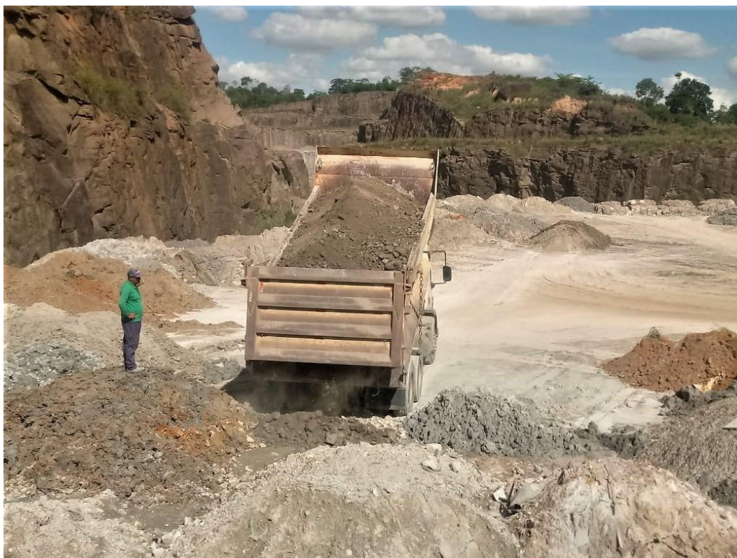
Figura 37 – Descarregamento da lama desaguada do beneficiamento de granitos na célula da Área 2 em dezembro de 2019.
