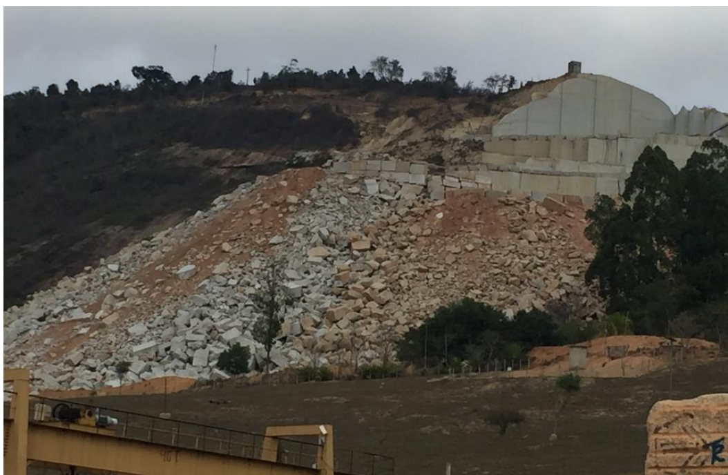
Figura 85 – Rejeitos da exploração, incluindo blocos dimensionados descartados por possuírem padrões estéticos indesejáveis, em pedreira situada no norte do ES.
