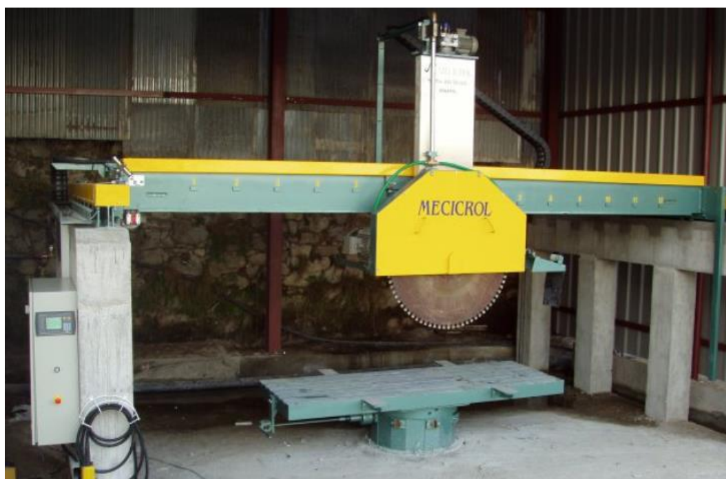
Figura 8 – Vista de serra talha blocos. Fonte: MECICROL, 2020.
