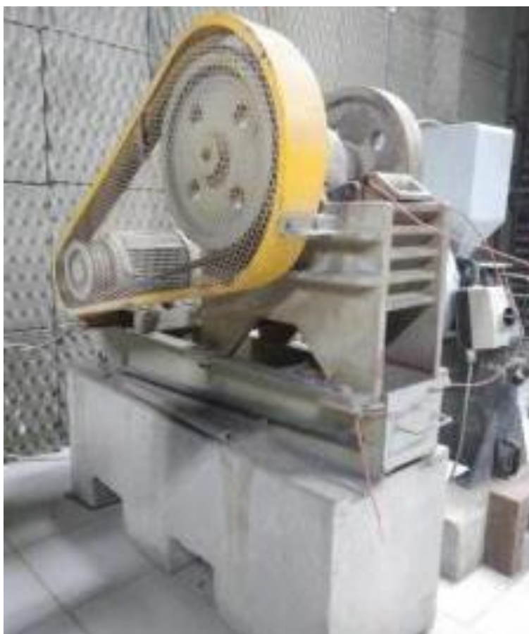
Figura 47 – Britador de mandíbula utilizado para britagem dos casqueiros de granitos pesquisados (LEMAC/UFES). Fonte: Extraído de < http://lemac.ufes.br/britadores > em 16 de abril de 2020.
