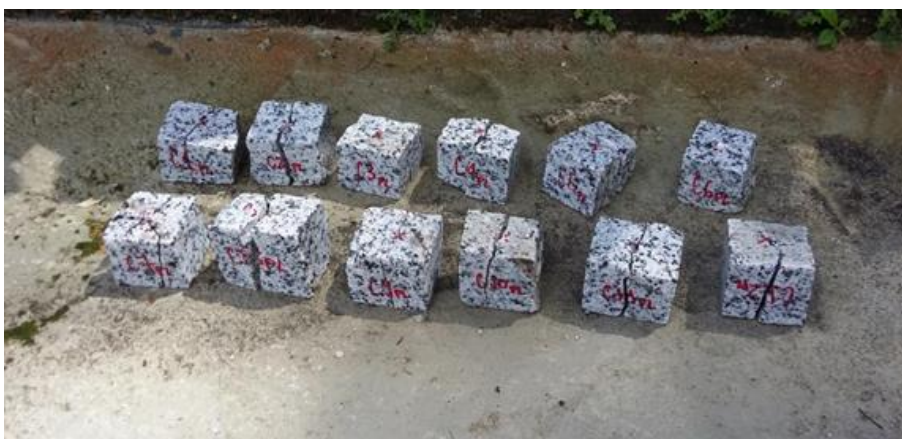
Figura 97 – Corpos de provas do granito cinza andorinha após a ruptura no ensaio de resistência à compressão à carga puntiforme.
