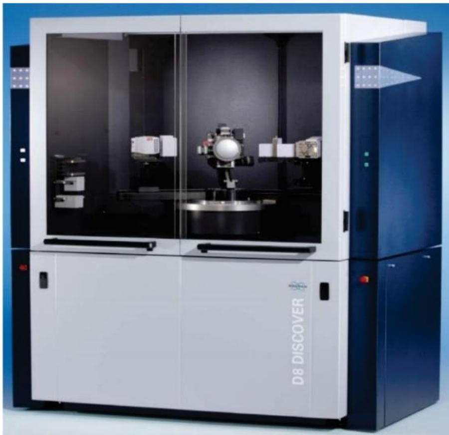
Figura 56 – Difratômetro utilizado nos ensaios de Difração de Raios-X. Fonte: Laboratório do DEQM/PUC-Rio.
