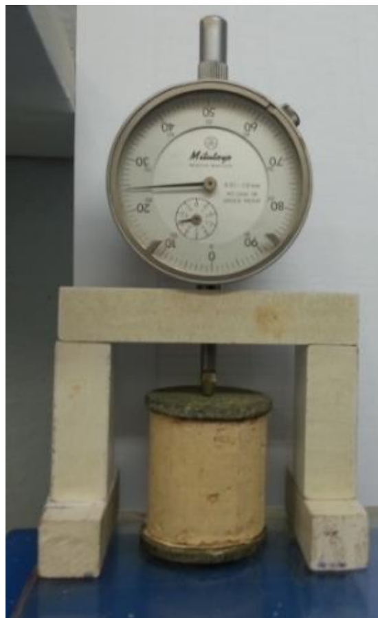
Figura 59 – Equipamento para realização do ensaio de contração volumétrica. Fonte: Freitas, 2015.
