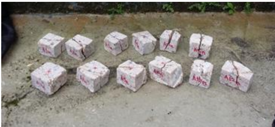
Figura 96 – Corpos de provas do granito amarelo após a ruptura no ensaio de resistência à compressão à carga puntiforme.
