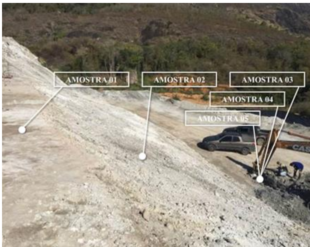
Figura 67 – Ilustração dos locais de coleta das 5 amostras da lama do beneficiamento de granitos no maciço de rejeitos em junho de 2016.
