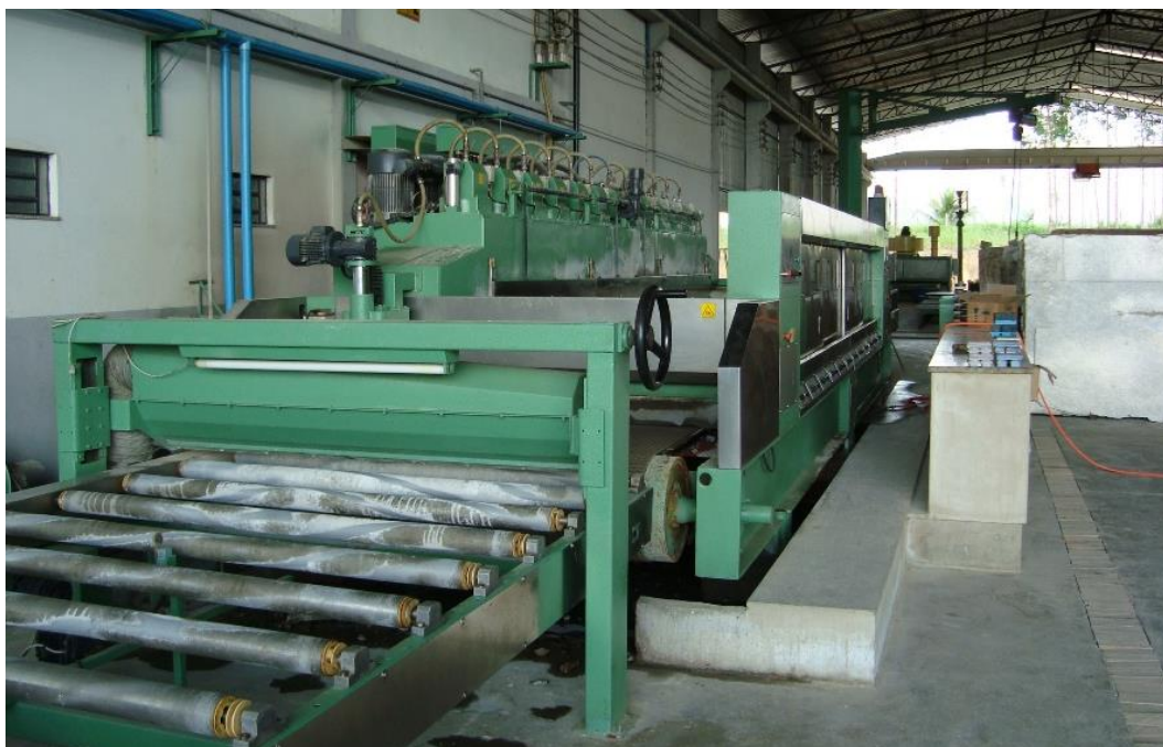
Figura 9 – Politriz com cabeçotes rotativos instalada em indústria de beneficiamento de granito no município de Nova Venécia, norte do ES.
