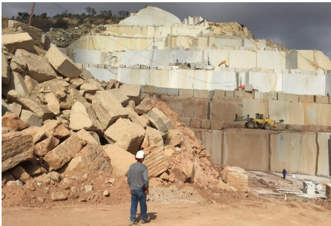
Figura 83 – Depósito de rejeitos (solo e pedaços de rochas) posicionados sobre a própria jazida de granito amarelo em pedreira situada no norte do ES.
