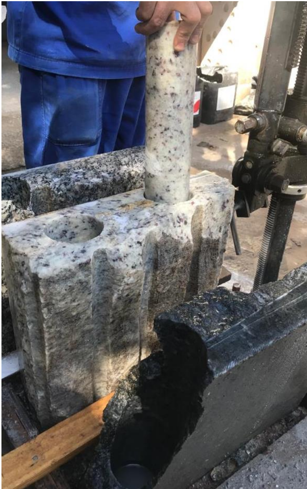
Figura 49 – Corpo de prova de granito extraído com a plugadeira, para os ensaios de resistência à compressão simples.
