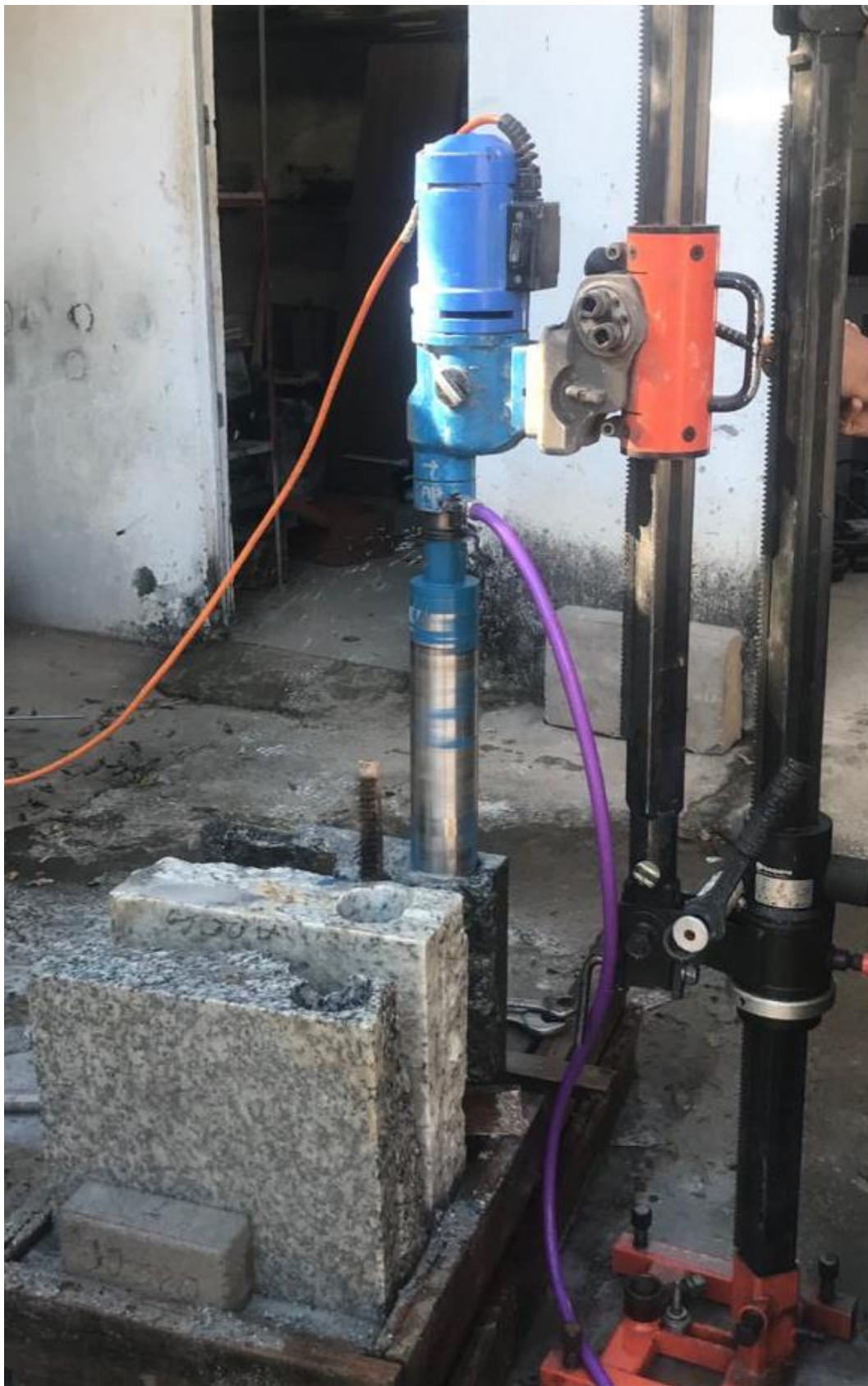
Figura 48 – Detalhe da preparação de corpos de prova de granito com a plugadeira, para os ensaios de resistência à compressão simples.
