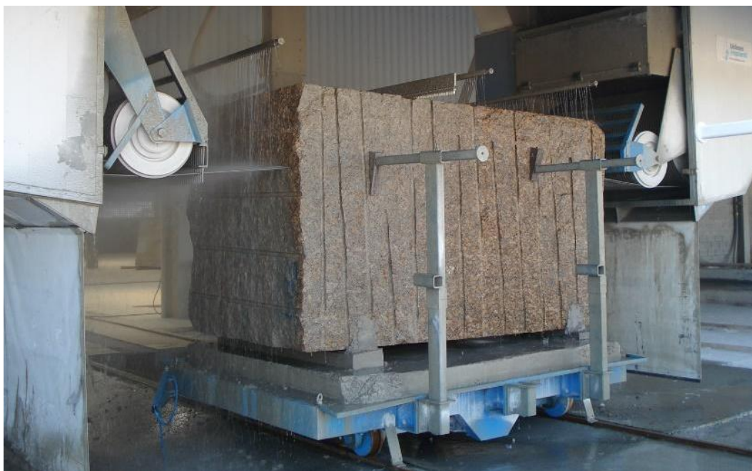
Figura 7 – Bloco de granito sendo desdobrado em tear multifios diamantados.
