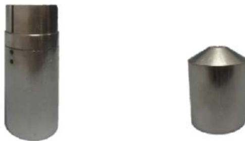
Figura 3.15: Rotor e o Bob do viscosímetro.
