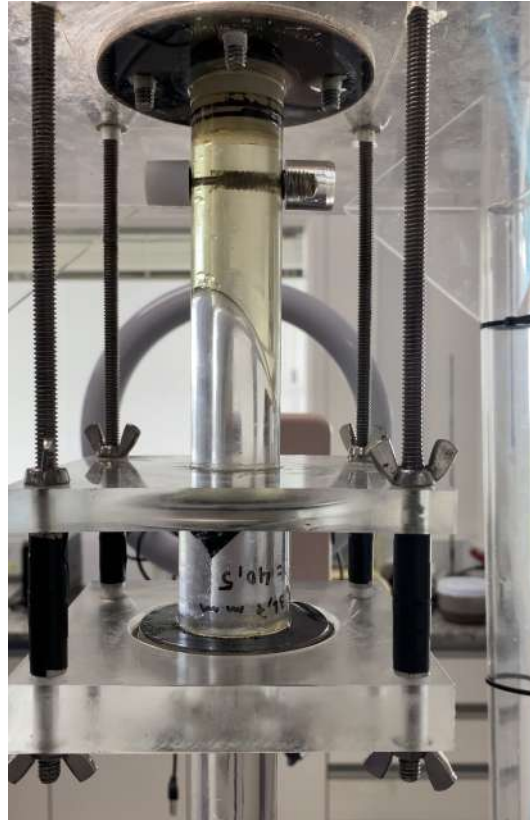
Figura 4.18: Formato da interface água-óleo do teste com excentricidade 25% a 4,4 \times 10^{-6} m^3/s .
