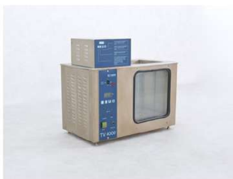
Figura 3.13: Viscosímetro Ubbelohde e o banho termostático.
