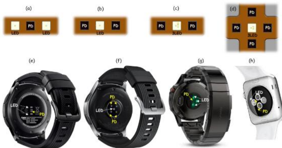
Figura 29- Exemplos de configurações de sensores PPG que utilizam múltiplos LEDs e PDs, e sua aplicação em smartwatches comerciais. (a-d) ilustram diferentes estruturas de sensores PPG, enquanto (e) a (h) apresentam exemplos dessas estruturas em uso: (e) estrutura (a) aplicada ao Samsung Galaxy Gear S3 ; (f) estrutura (d) aplicada ao Samsung Galaxy Watch ; (g) mostra a estrutura do sensor do Garmin Fenix 5 com três LEDs e um PD no centro, e (h) mostra a estrutura do sensor do Apple Watch com dois LEDs e dois PDs. [53]
