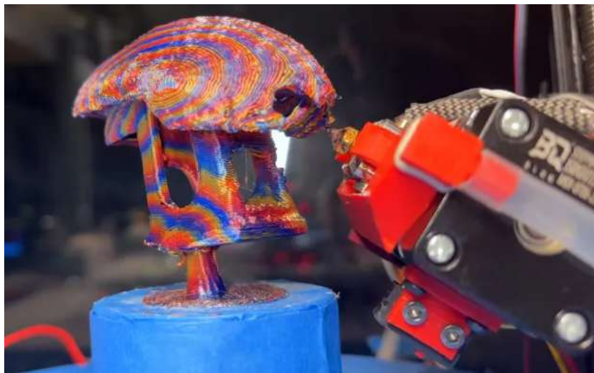
Figura 3.2: Exemplo de hotend modificado para impressão não-planar, podendo fazer extrusão em praticamente qualquer direção.
