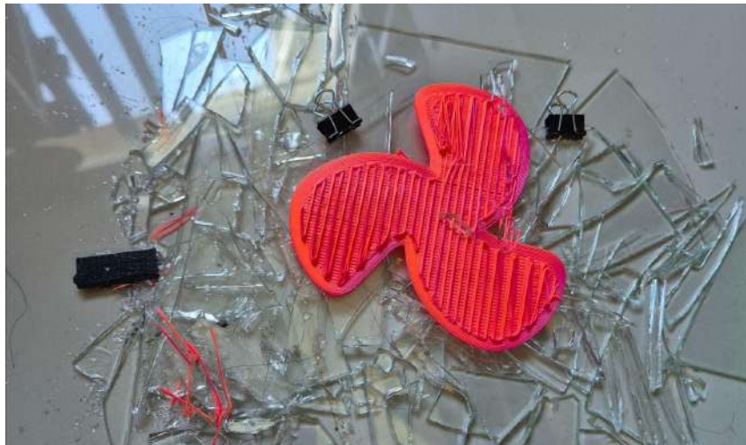
Figura 1.8: Colisão durante processo de impressão 3D não planar Próprio Autor
