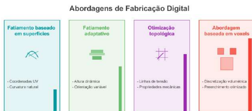
Figura 3.3: Diagrama comparativo das principais abordagens computacionais para geração de trajetórias não-planares.
