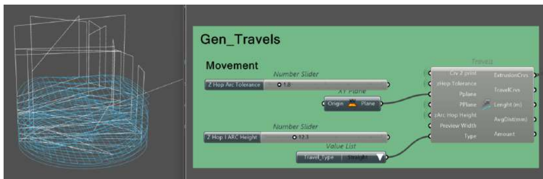
Figura 5.22: Travels (z-hop): deslocamento vertical linear entre trajetórias.
