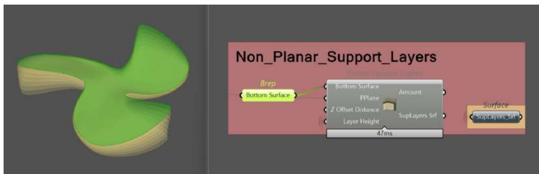
Figura 5.15: Tween Support Layers: superfícies de suporte otimizado até o plano base.
