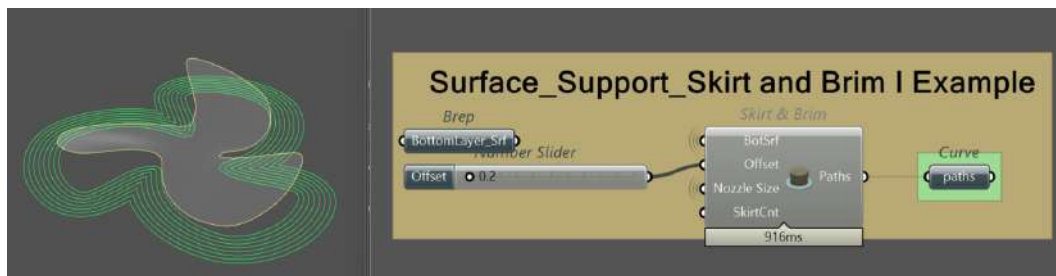
Figura 5.20: Skirt & Brim: anéis de fixação configuráveis para melhorar a aderência inicial.
