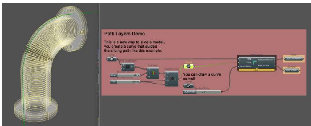
Figura 5.12: Path Layers: seccionamento perpendicular a uma curva de referência.
