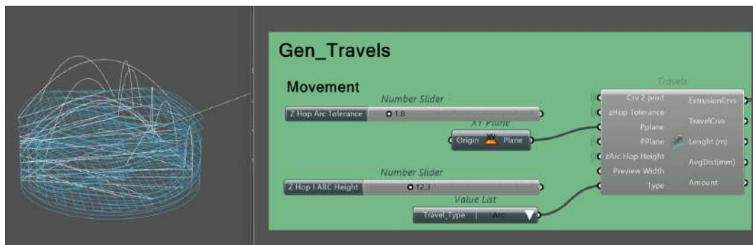
Figura 5.21: Travels (Arc z-hop): deslocamento em arco para evitar colisões.
