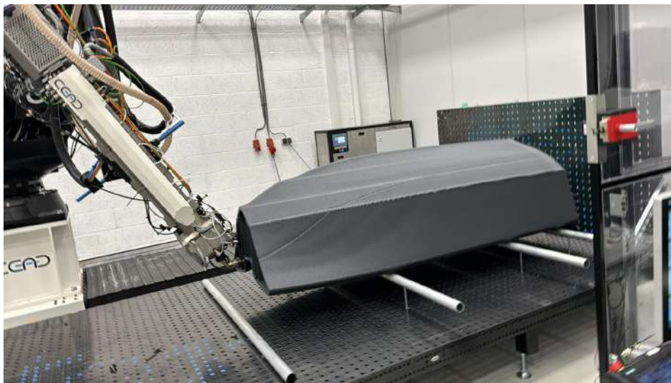
Figura 4.7: Robô industrial imprimindo casco horizontalmente ( Flexboat /CEAD).
