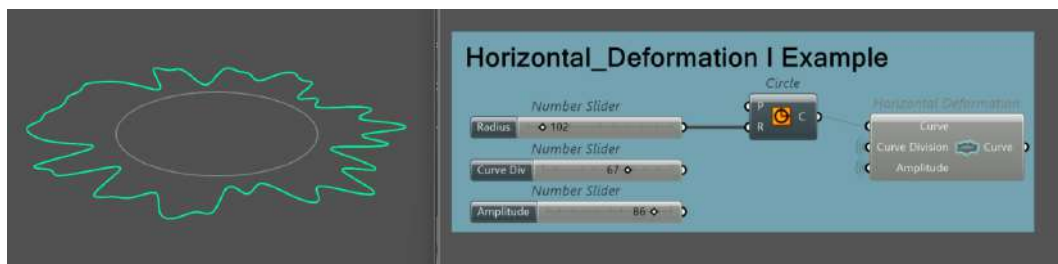
Figura 5.24: Horizontal Deformation: modificação paramétrica de curvas no plano XY. Autor
