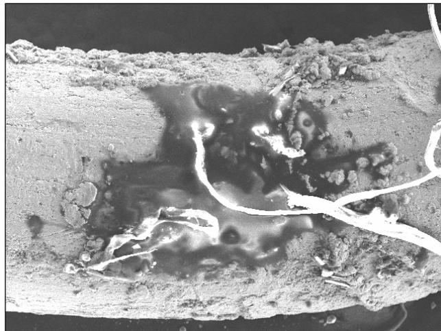
Figura 5.7 - Verificação da formação de poros na superfície do eletrodo de prata após ensaios de potencial em circuito aberto do  $\text{FeS}_2$  em sais fundidos. 150 X.
