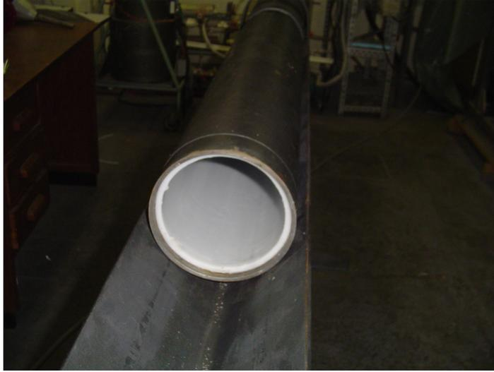
Figura 32 – Posicionamento do tubo com depósito na seção de teste
