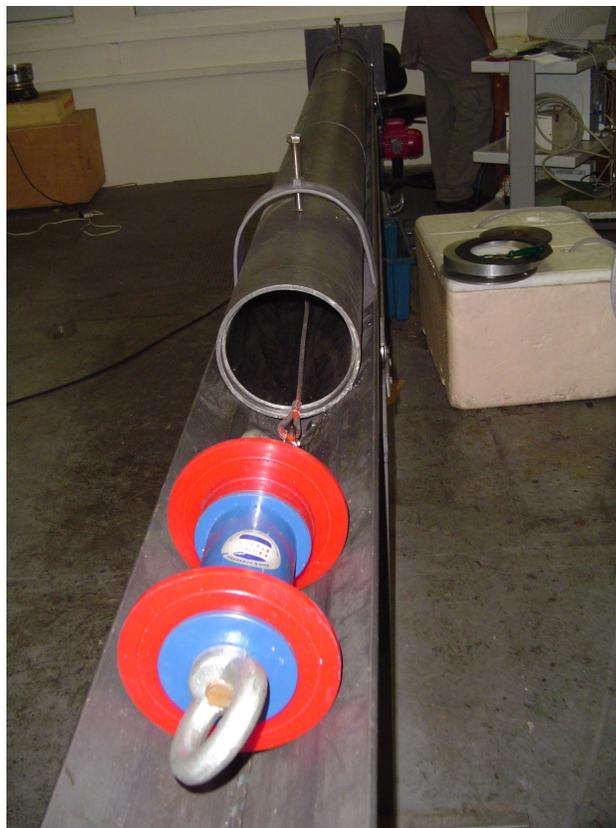
Figura 33 – Posicionamento do pig no aparato experimental
