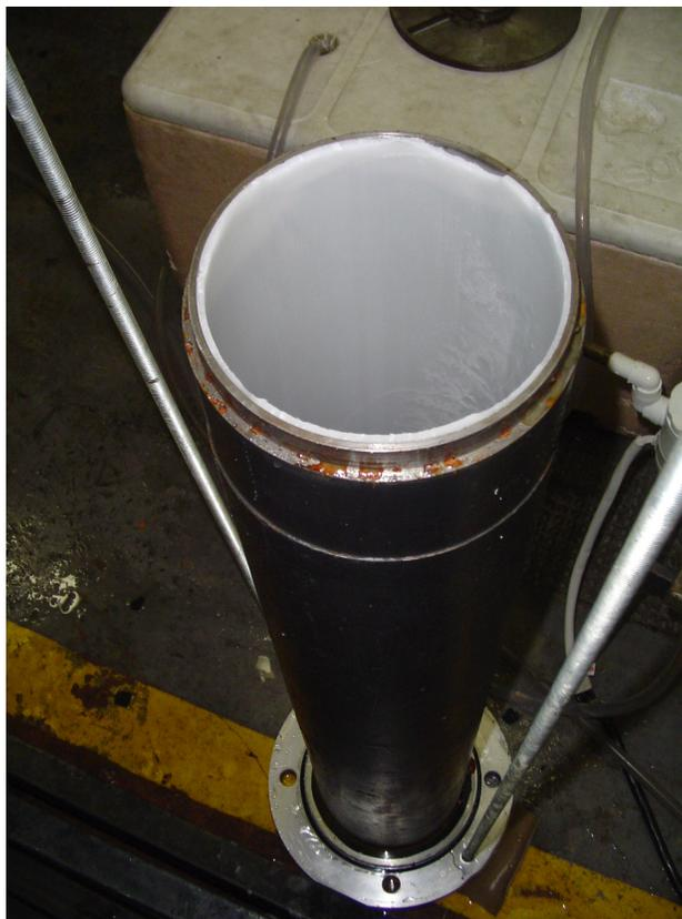
Figura 30 – Detalhe da desmontagem do dispositivo para deposição de parafina
