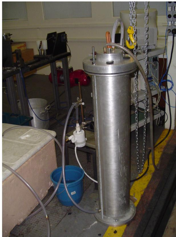
Figura 27 – Dispositivo para deposição de parafina
