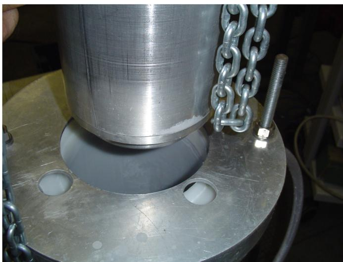
Figura 29 – Retirada do tubo macho com a talha manual
