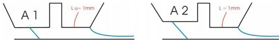
Figura 1.8 - Configurações externas da barra de revestimento: A1 de lábios uniformes, A2 tipo "Overbite".
