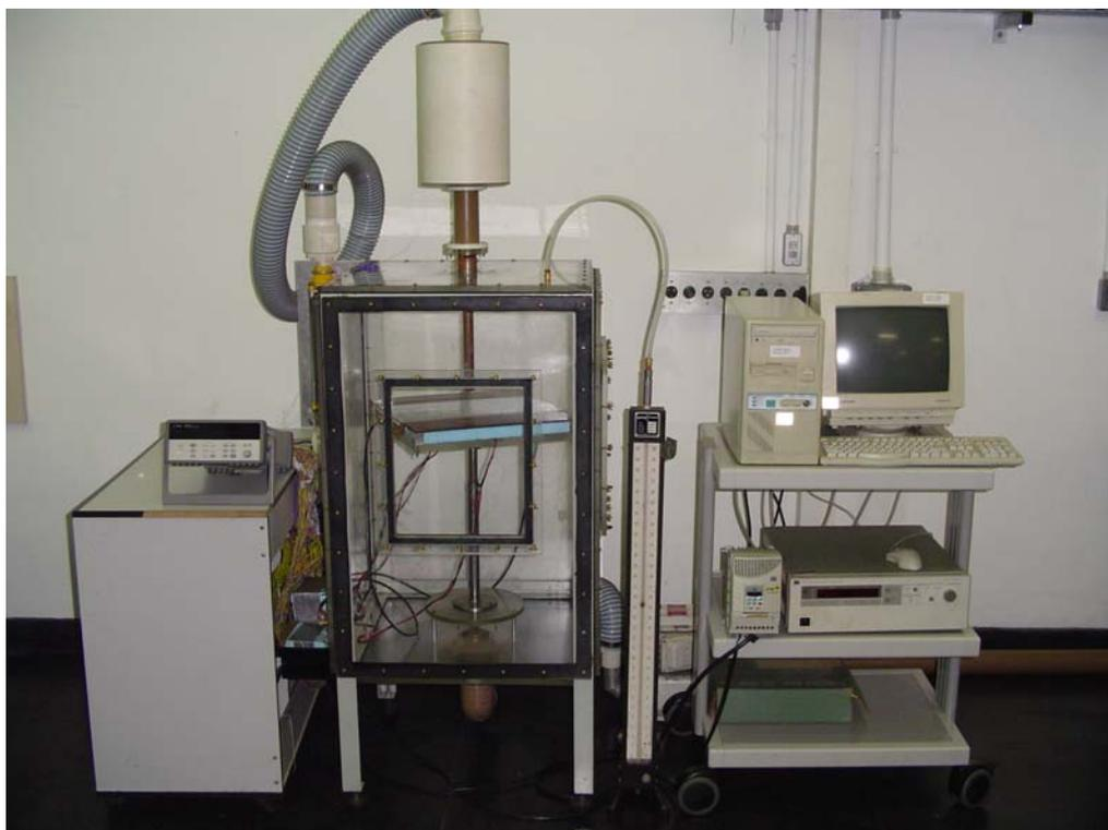
Figura 3.3 - Seção de testes preparada para experimento de transferência de calor
