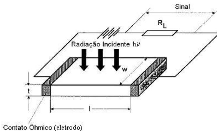
Figura 1.2 – Esquema de operação de um fotocondutor.
