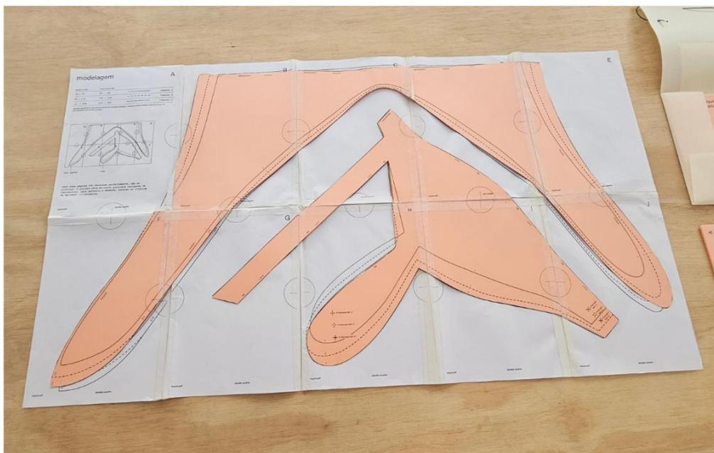
Figura 21: Folha de molde montada para uso; Fonte: Autorial.
