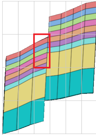
Figura 4.11: Descontinuidade na geometria do modelo, dentro de um voxel , causada por uma falha geológica.
