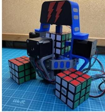
Figura 2: Robô solucionador de cubo mágico com motor de passo
