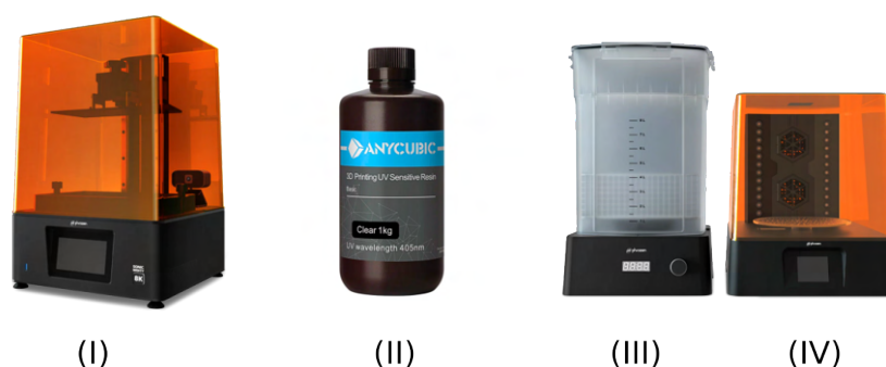
Figura 4.12: (I) Impressora 3D, (II) resina, (III) lavadora e (IV) cura.
