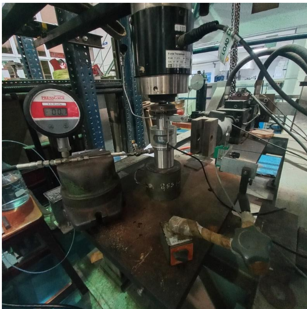
Figura 3.16 Processo de calibração da célula de carga hidrostática
