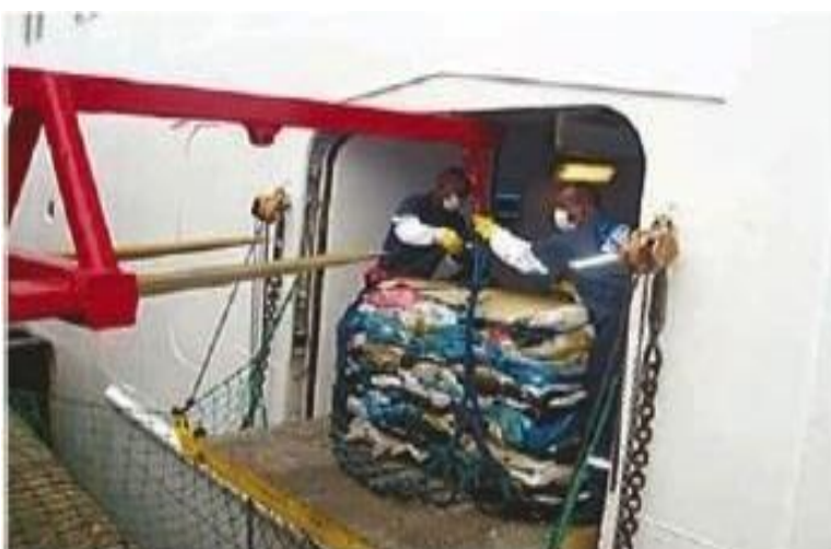
Figura 4 – Transbordo com utilização de talha e rede. Registro do autor
