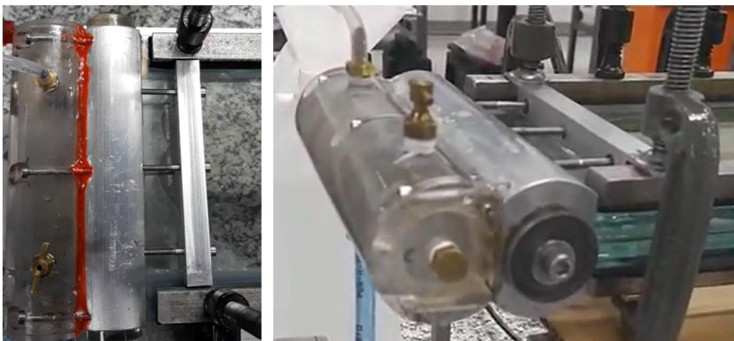
Figura 4.2: Reservatório 1 em acrílico e reservatório 2 em alumínio usado para evitar que o fluido no interior da célula recuasse.
