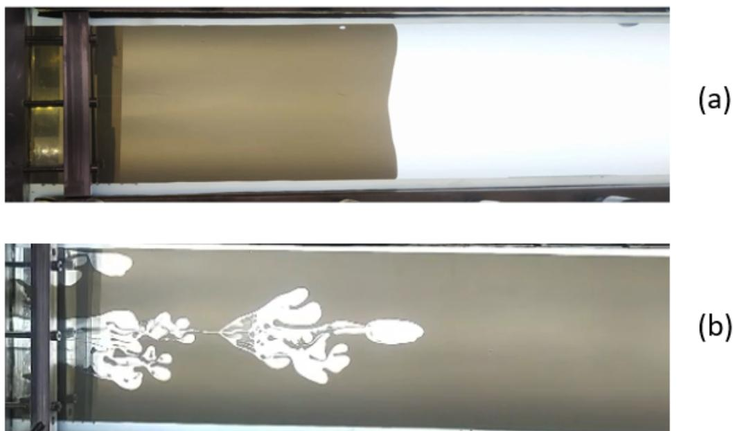
Figura 2.1: Exemplo experimental de interfaces obtidas durante experimentos de escoamento de dois fluidos realizados no laboratório GReo (Grupo de Reologia). Em (a) temos uma interface estável, em (b), podemos verificar uma interface instável e a presença de dedos viscosos quando o escoamento é inverso, ou seja, óleo deslocando glicerina.
