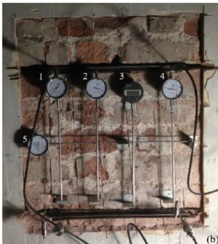
Figura 3.7 –Realização do ensaio de macaco plano duplo no TMRJ.
