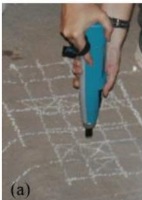
Figura 3.5 – Realização do ensaio de esclerometria no TMRJ. Fonte: Cintra (2019)
