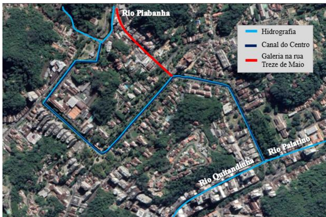
Figura 38 - Esquema da solução da galeria extravasora da rua Treze de Maio.
