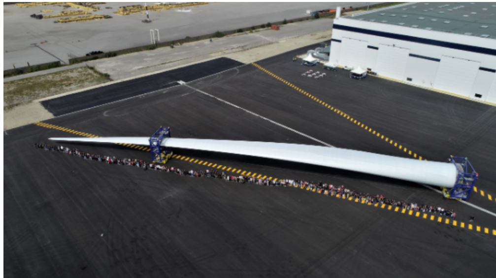
Figura 15 - Pá Eólica com 107 m de comprimento.
