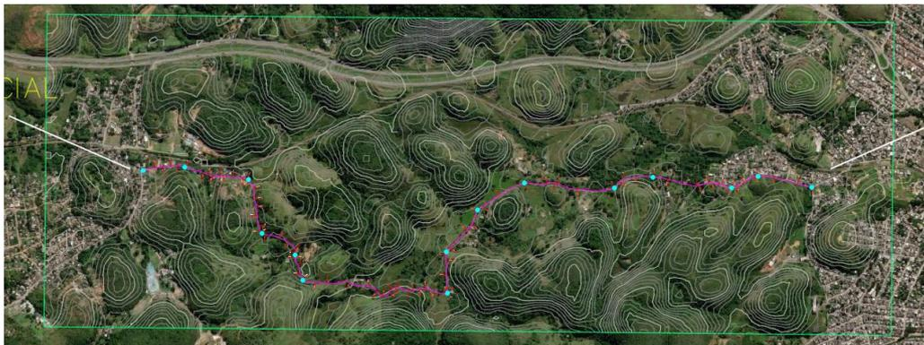
**Figura 35: Superfície criada a partir das curvas de nível da região (Autoria Própria)**
