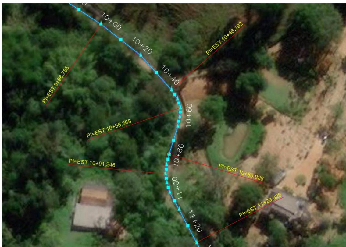
Figura 40: PI's Secos do Trecho do Alinhamento Existente (Autoria Própria)
