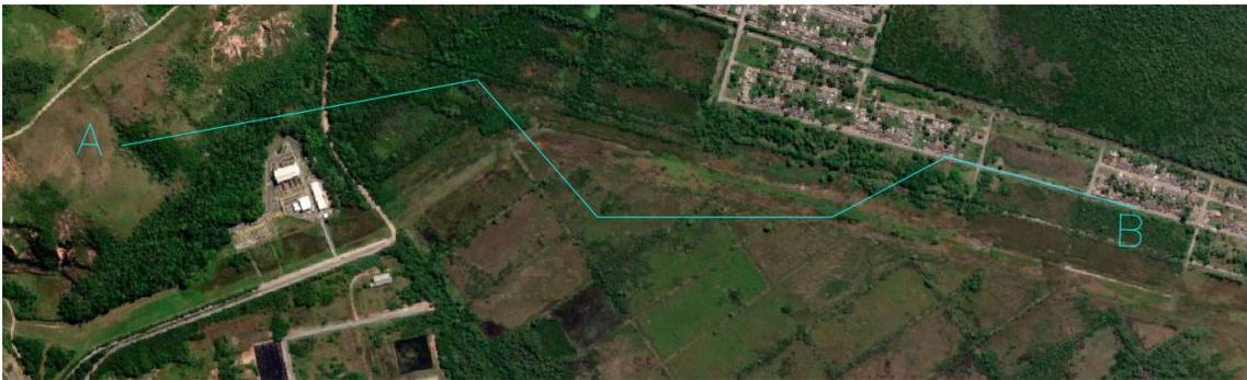
**Figura 27: Representação de Alinhamento Reto Horizontal do ponto A ao ponto B sem ângulos agudos (Autoria Própria)**
