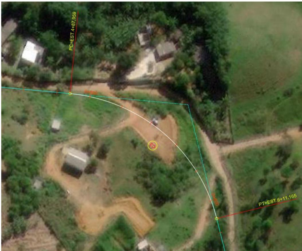
Figura 52: Exemplo de Curva Circular Simples com  $R=100m$  no Traçado projetado (Autoria Própria)
