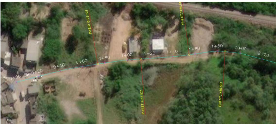
**Figura 38: Labels dos PI's secos e Estaqueamento definido (Autoria Própria)**
