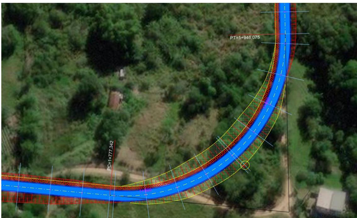
Figura 59: Corredor Modelado a partir do eixo de alinhamento projetado (Autoria Própria)
