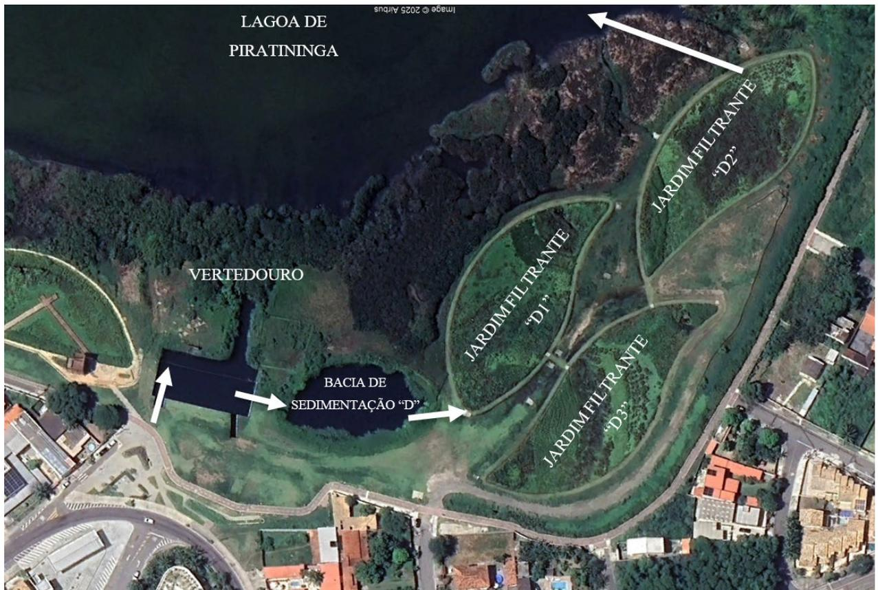
Figura 3.23 Sequência de Funcionamento dos Jardins Filtrantes através de imagem via satélite. Fonte: Google Earth adaptada
