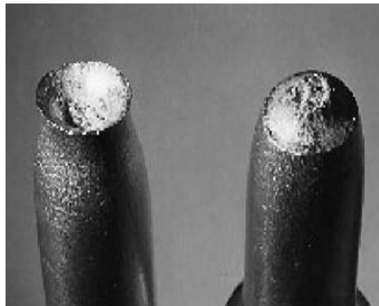
Figura 5: Corpo de prova – fratura dúctil [47]
