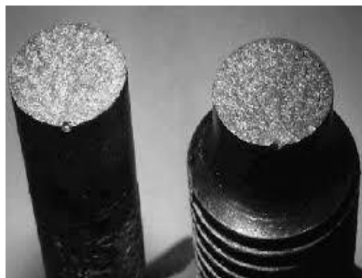
Figura 4: Corpo de prova – fratura frágil [47]
