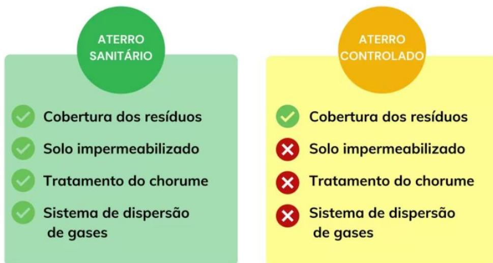
Figura 3 - Diferenças principais entre os Aterro Sanitário x Controlado.
