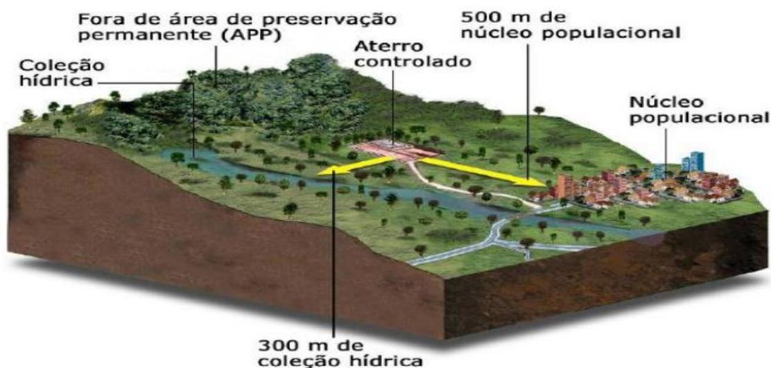
Figura 1 - Esquema de um aterro controlado com as medidas mínimas de redução de impactos ambientais.
